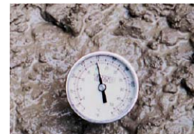
Fig. 7-5 Se usa un termómetro para medir la temperatura del concreto fresco.
