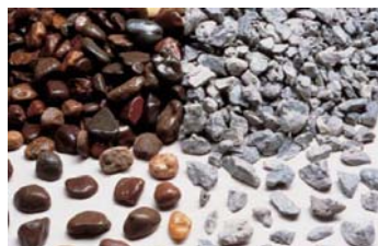
Fig. 3-4. Agregado grueso. Grava redondeada (izquierda) y piedra triturada (derecha).
