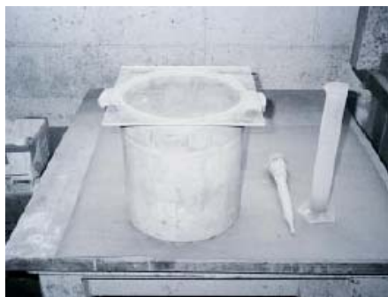
Fig. 7-13. Ensayo de sangrado (exudación) del concreto de acuerdo con la ASTM C 232 (AASHTO T 58); método A, sin vibración. El recipiente tiene un diámetro interno de cerca de 255 mm (10 pulg.) y altura de 280 mm (11 pulg.). El recipiente se llena hasta una altura de 255 mm (10 pulg.) y se lo cubre para prevenir la evaporación del agua de sangrado.
