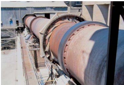
Fig. 2-8. Horno rotatorio para la manufactura del clínker de cemento. La foto menor, abajo y a la derecha trae una vista del interior del horno.
