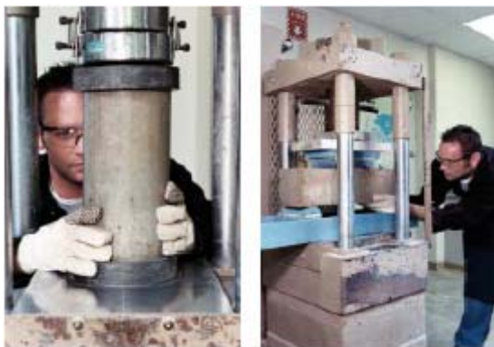
Fig. 7-14. Ensayo del concreto endurecido: (izquierda) cilindros, (derecha) viga.
