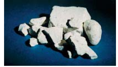
Fig. 2-9. El clinker de cemento portland se forma por la calcinación en el horno del material crudo calcáreo y sílice. Este clinker específico tiene un diámetro de 20 mm (3/4 pulg.)
