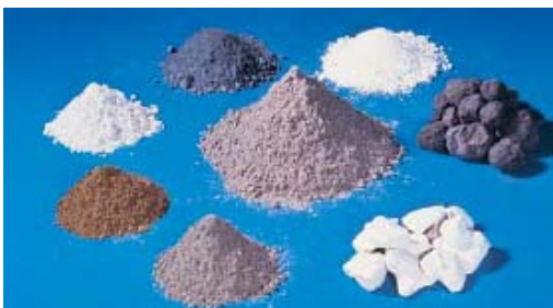
Fig. 2-17. Los cementos adicionados usan una combinación de cemento portland o clínker y yeso mezclados o molidos conjuntamente con puzolanas, escorias o ceniza volante. La ASTM C 1175 permite el uso y la optimización de todos estos materiales, simultáneamente si necesario, para producirse un cemento con propiedades óptimas. Se enseñan el cemento adicionado (al centro) rodeado por (derecha y en el sentido del reloj) clínker, yeso, cemento portland, ceniza volante, escoria, humo de sílice y arcilla calcinada
