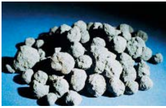
Fig. 2-9. El clinker de cemento portland se forma por la calcinación en el horno del material crudo calcáreo y sílice. Este clinker específico tiene un diámetro de 20 mm (3/4 pulg.)
