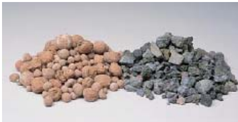
Fig. 3-5. Agregado ligero. Arcilla expandida (izquierda) y esquisto expandido (derecha).
