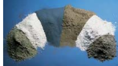
Fig. 3-1. Materiales cementantes suplementarios. De la izquierda para la derecha, ceniza volante (Clase C), metacaolinita (arcilla calcinada), humo de sílice, ceniza volante (Clase F), escoria y esquisto.
