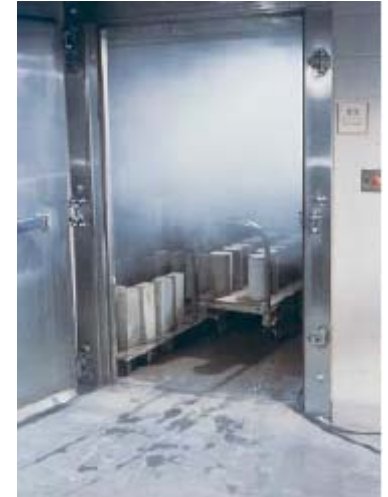
Fig. 7-11. Curado húmedo controlado en laboratorio de especímenes estándar con humedad relativa de 95% a 100% y temperatura de 23\pm 2^{\circ}\text{C} ( 73\pm 3^{\circ}\text{C} ) (ASTM C 511 o AASHTO M 201).
