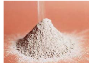
Fig. 2-1. El cemento portland es un polvo fino que cuando se mezcla con el agua se convierte en un pegamento que mantiene los agregados unidos en el concreto.
