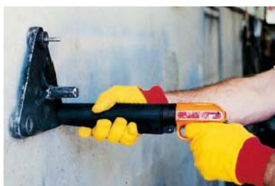
Fig. 7-21. La técnica de sondeo de Windsor para determinar la resistencia a compresión relativa del concreto. (Superior) Pistola accionada por pólvora clava una sonda de aleación hacia adentro del concreto. (Izquierda) Se mide la longitud de la sonda expuesta y, a través de una tabla de calibración, se determina la resistencia a compresión del concreto.
