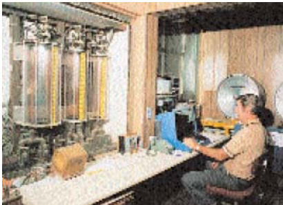
Fig. 3-22. El dosificador de aditivo líquido en una planta de concreto premezclado da una medida volumétrica precisa de los aditivos.
