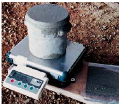
Fig. 7-6. Se pesa el concreto fresco en un recipiente de volumen conocido para la determinación de la masa volumétrica.
