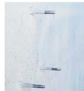
Fig. 7-21. La técnica de sondeo de Windsor para determinar la resistencia a compresión relativa del concreto. (Superior) Pistola accionada por pólvora clava una sonda de aleación hacia adentro del concreto. (Izquierda) Se mide la longitud de la sonda expuesta y, a través de una tabla de calibración, se determina la resistencia a compresión del concreto.
