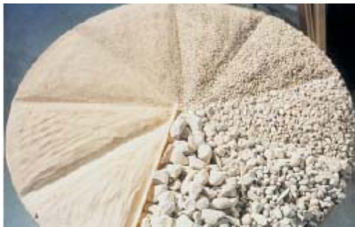
Fig. 3-6. Varios tamaños de partículas que se encuentran en los agregados para uso en concreto
