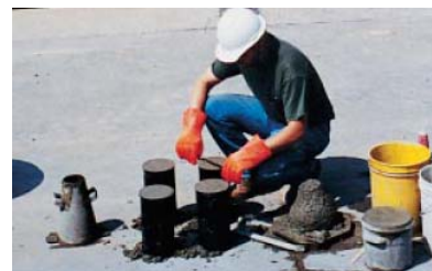
Fig. 7-9. Preparación de los especímenes estándar para la prueba de resistencia a compresión del concreto.
