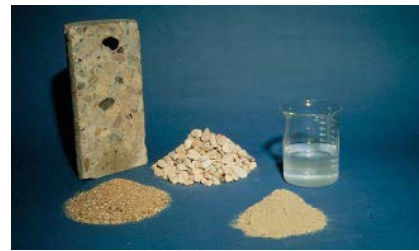
Fig. 1-1. Componentes del concreto: cemento, agua, agregado fino, agregado grueso, son combinados para formar el concreto.
