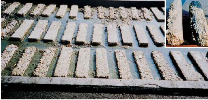
Fig. 1-32. Vigas de concreto después de muchos años de exposición a un suelo con alta concentración de sulfatos en Sacramento, California, terreno de ensayo. Las vigas en mejores condiciones tienen bajas relaciones agua-materiales cementantes y muchas de ellas tienen cemento resistente a sulfatos. La foto menor, a la derecha en la parte superior, enseña dos vigas inclinadas sobre sus laterales para mostrar niveles decrecientes de deterioro con la profundidad y el nivel de humedad
