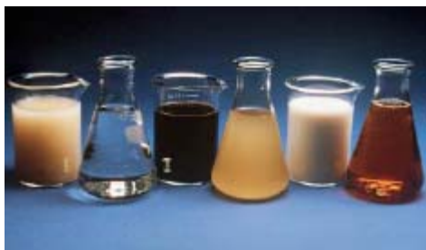
Fig. 3-12. Aditivos líquidos, de la izquierda hacia la derecha: aditivo antideslave, reductor de retracción, reductor de agua, agente espumante, inhibidor de corrosión y incorporador de agua
