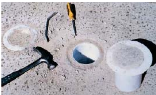
Fig. 7-14. Los cilindros de concreto colados en el sitio en un molde cilíndrico ayudan en la determinación de la resistencia a compresión del concreto de la estructura.
