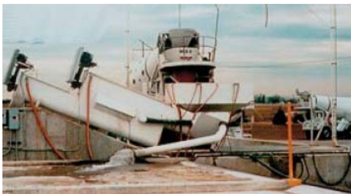
Fig. 3-2. Los sistemas de recuperación permiten el uso inmediato del agua de lavado en el mezcla.
