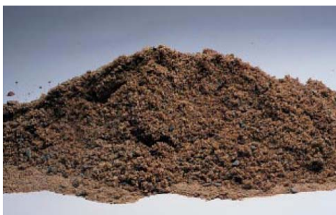
Fig. 3-3. Primer plano de agregado fino (arena).
