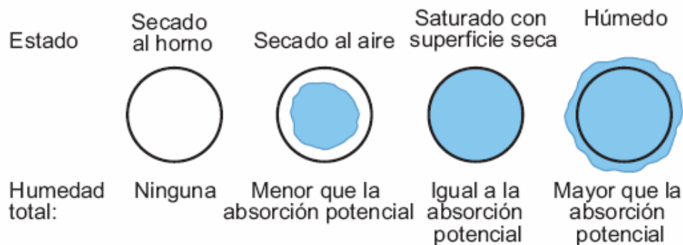
Fig. 3-9. Condiciones de humedad de los agregados.
