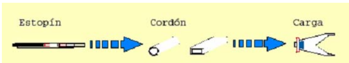
Figura 2.11. Componentes del sistema de disparo. (OILPRODUCTION.COM)
