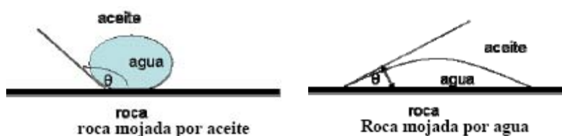
Figura 2.29. Superficie mojada por agua y aceite, el ángulo de contacto cambia por la tensión interfacial distinta. (ARTICULO: ADSORCIÓN Y MOJABILIDAD)
