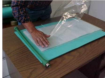
2. Colocación de la membrana superior.
