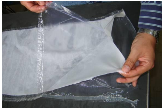
Figura 4.8. Fugas en el armado de los cartuchos.
