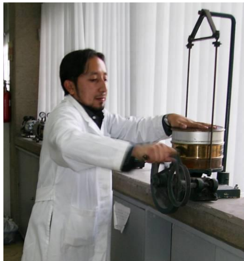
Figura 3.24. Realización del tamizado con diferentes mallas.
