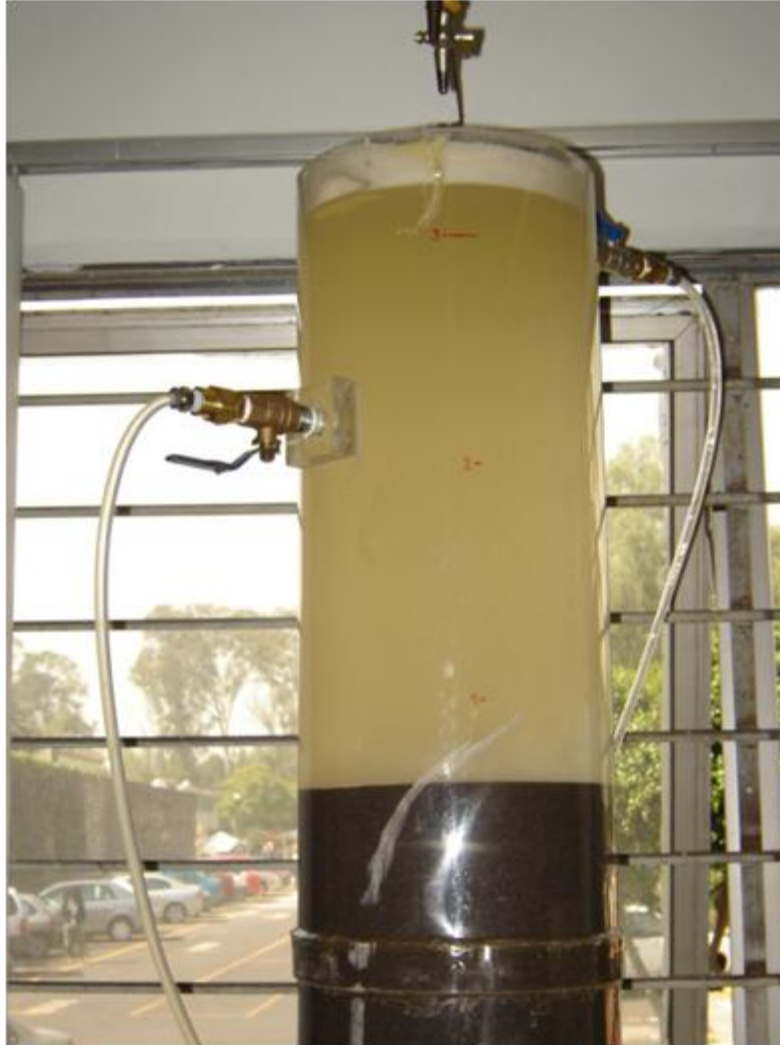
Figura 3.26. Retrolavado del filtro
