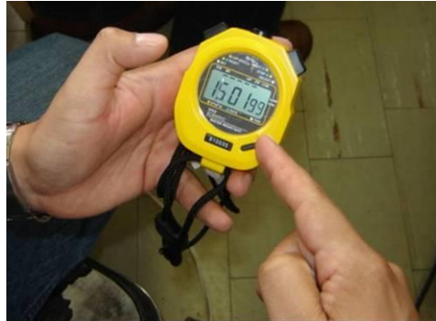
Figura 3.31. Medición de tiempo de llenado.
