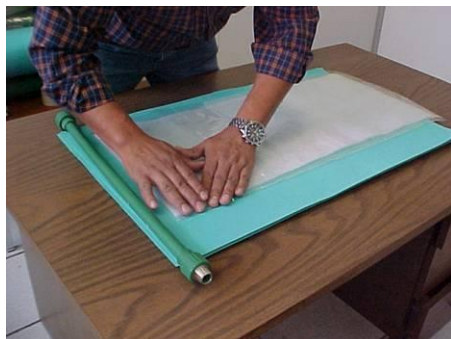
3. Sellado de los extremos aplicando presión.
