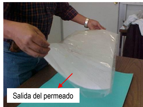
Figura 3.15. Formación del paquete de membrana superior e inferior, con una sola salida del permeado.
