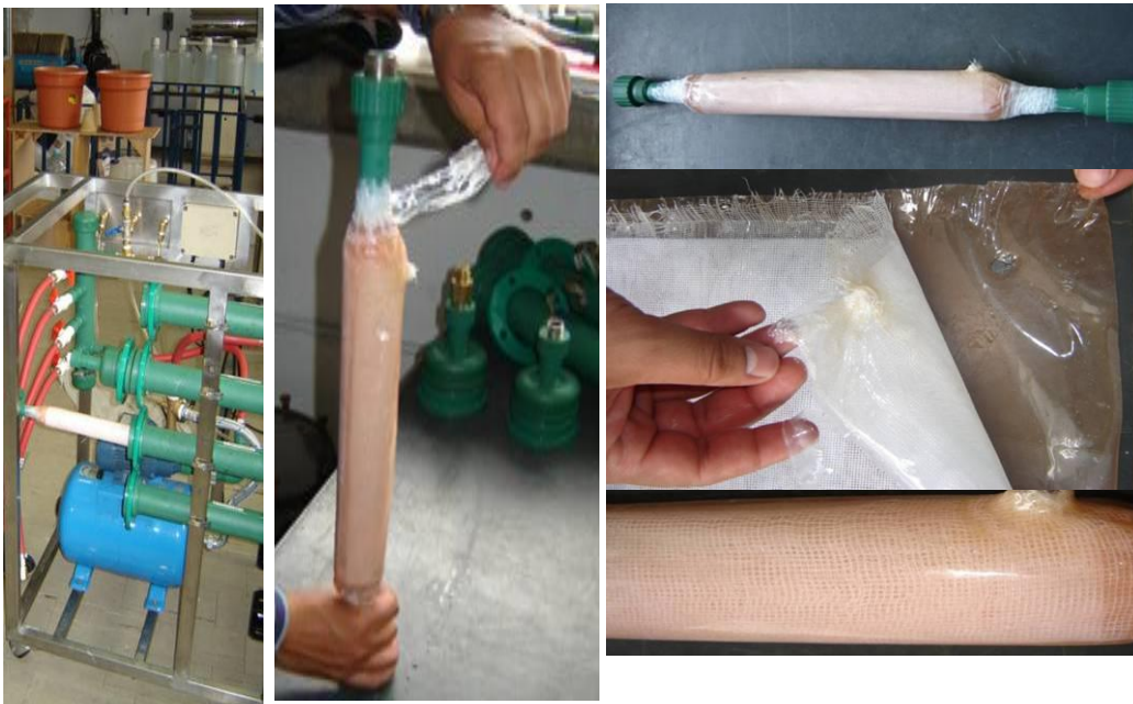
Figura 4.6. Ruptura de la membrana de los cartuchos
