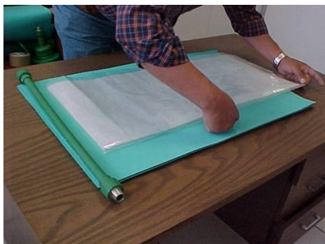
Figura 3.15. Formación del paquete de membrana superior e inferior, con una sola salida del permeado.
