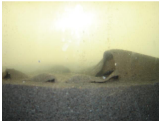
Figura 3.28. Resquebrajamiento de la costra formada en la parte superior del filtro.
