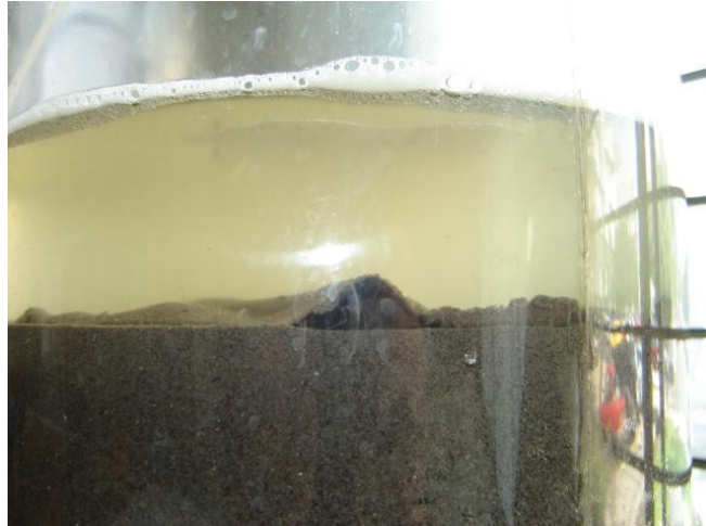
Figura 3.27. Costra formada en la parte superior del filtro.
