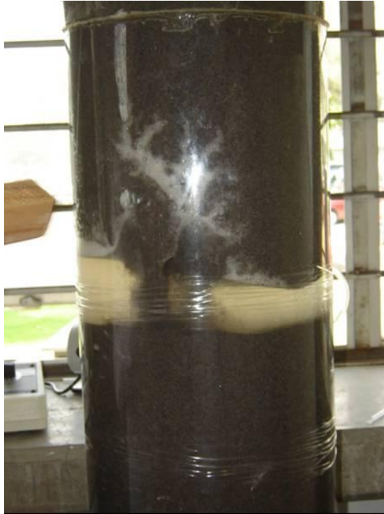
Figura 3.23. Expulsión de aire en la cama de arena.
