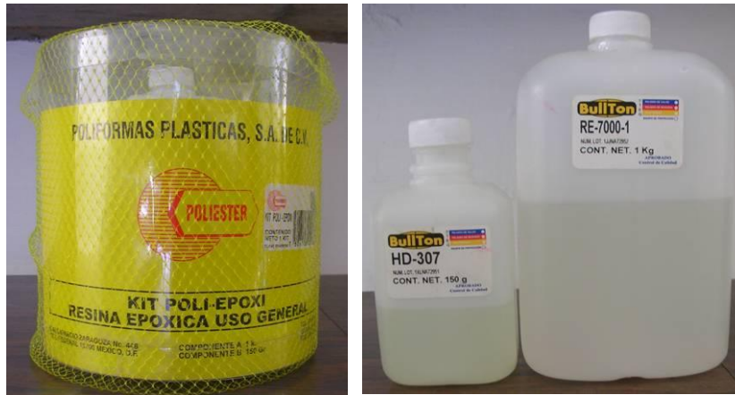
Figura 4.13. Resina epóxica empleada en el armado final de los cartuchos.
