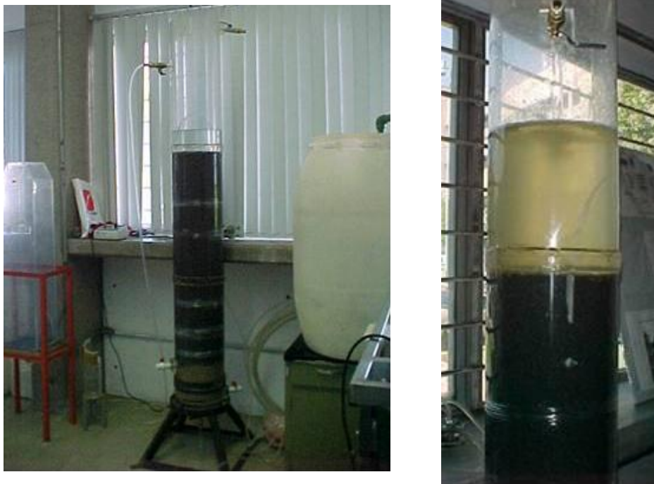
Figura 3.20. Filtro de arena.
