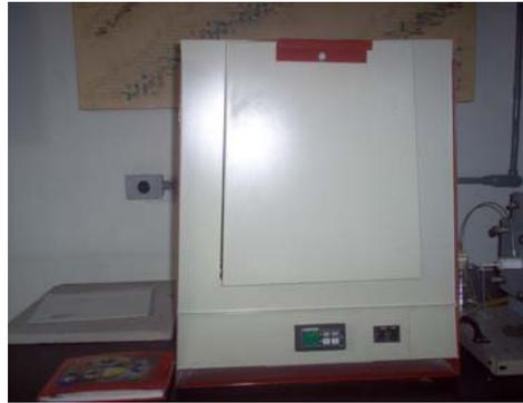
**Figura 2.3** Mufla utilizada para eliminar el polímero y llevar a cabo la sinterización.
