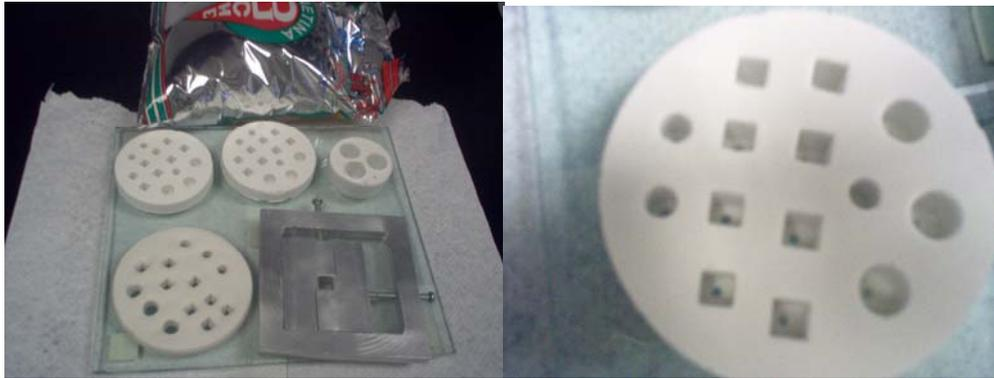
**Figura 2.2** Moldes de silicón con diferentes geometrías para la obtención de muestras cerámicas.
