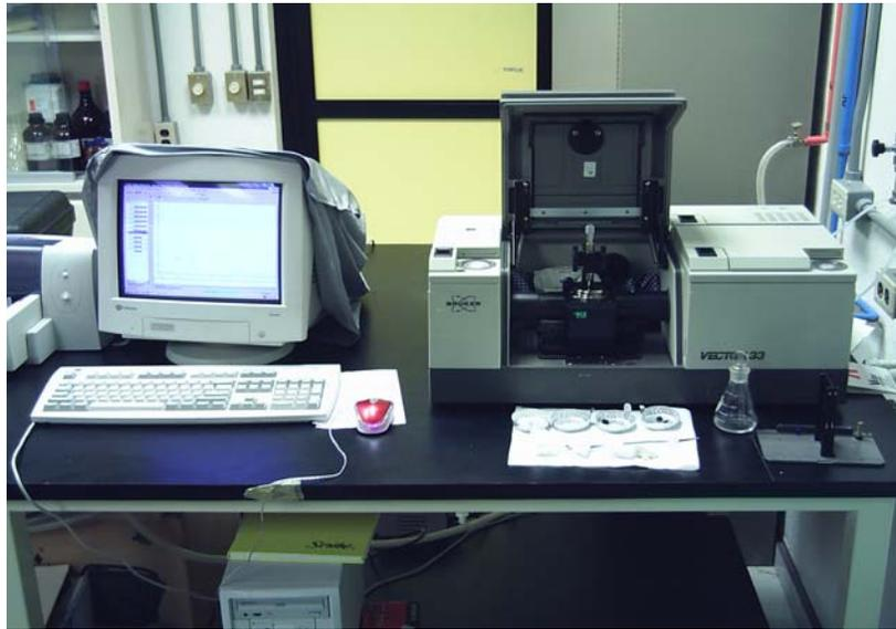
**Figura 3.11** Espectrómetro de infrarrojo marca Bruker modelo Vector 33.
