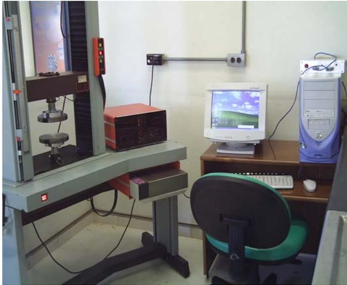
**Figura 3.19** Máquina universal de pruebas mecánicas de tensión y compresión, marca Adamel Lhomargy modelo DY.22
