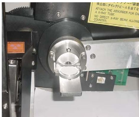
**Figura 3.7** Porta-muestra colocado en el Difractómetro de Rayos X.
