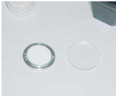
**Figura 3.6** Porta-muestra con el polvo de la muestra biocerámica
