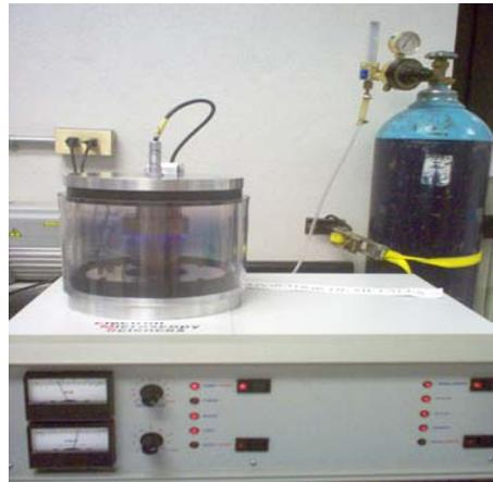
**Figura 3.17** Evaporadora marca EMS 550 sputter coater. Utiliza oro para recubrir las muestras.
