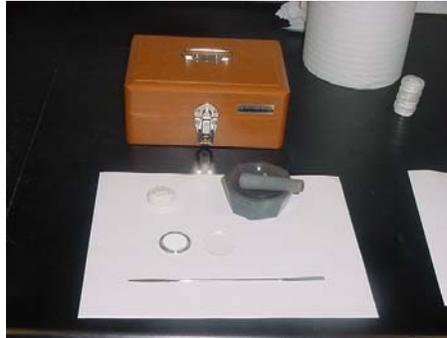
**Figura 3.5** Mortero de ágata, utilizado para moler la muestra.
