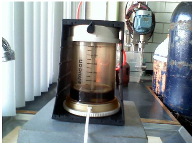
Fig. 2. Fotografía de una celda de ultrafiltración
