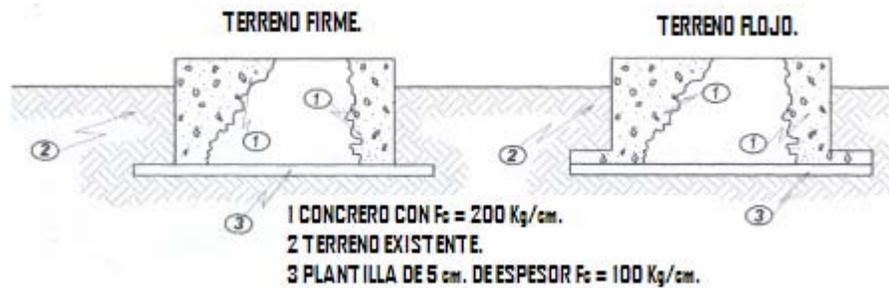
Figura 3.20. Base de cimentación para el montaje de Planta de Emergencia.
