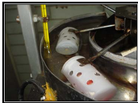
Figura 42. Muestras sumergidas a 55 \pm 1 °C (fd)
