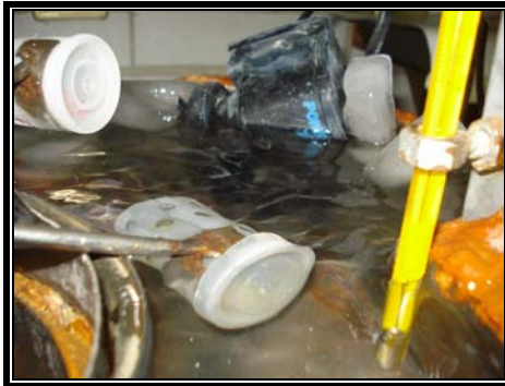
Figura 41. Muestras sumergidas a 5 \pm 1 °C (fd)
