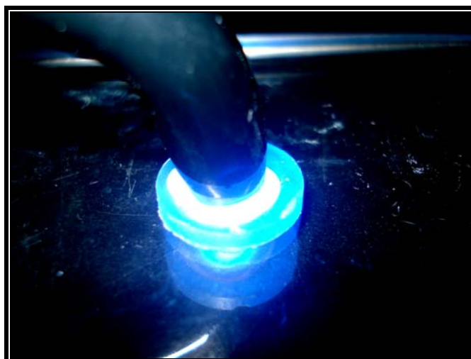
Figura 30. Fotopolimerización de la resina (fd)
