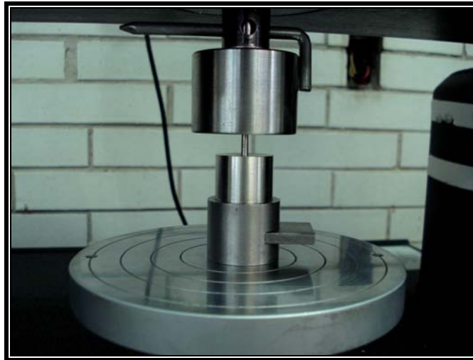
Figura 37. Base colocada en la máquina universal de pruebas mecánicas Instron (fd)
