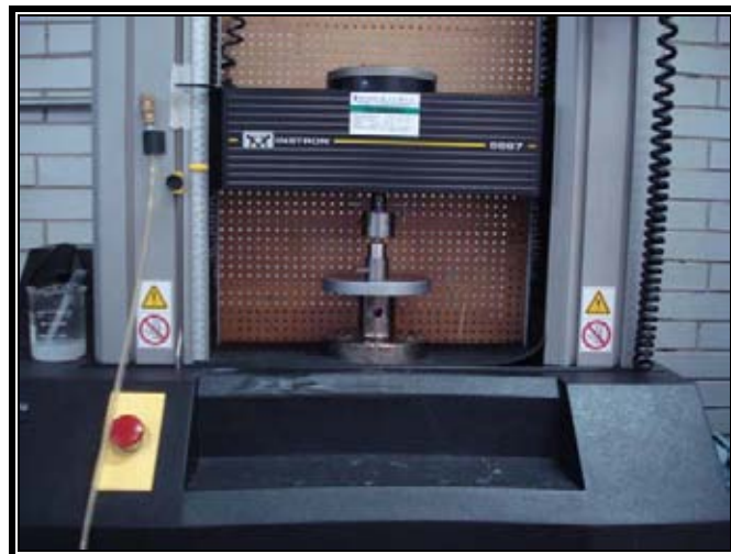
Figura 38. Aplicación de la carga 1mm por min. (fd)
