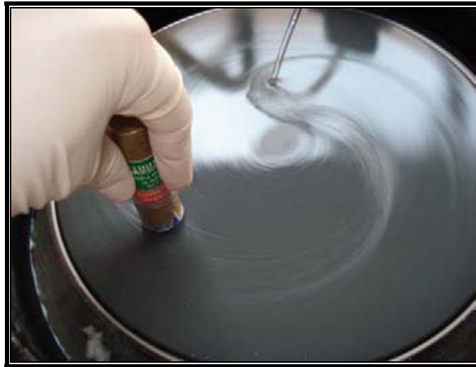
Figura 35. Muestra en el pulidor (fd)
