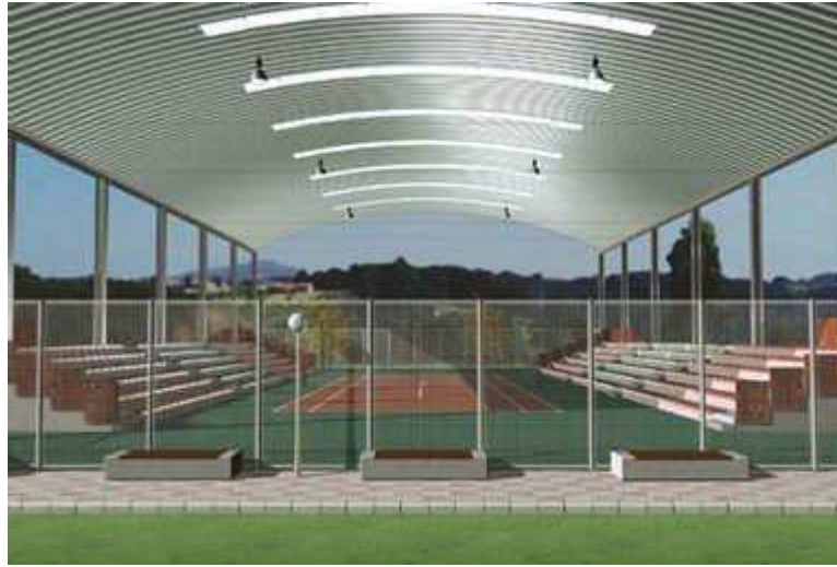
FIGURA 23. Diseño con programa CAD de una cubierta autoportante.
