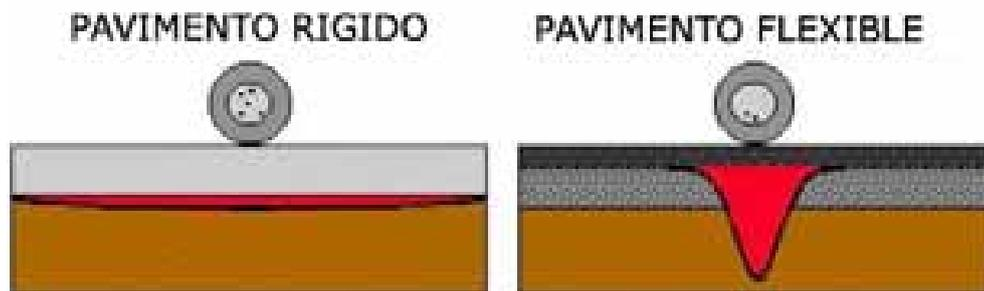
**Figura 1.3.** Disipación de la carga tanto para pavimentos rígidos y flexibles.
