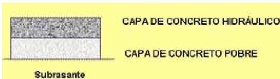
**Figura 1.1.** Ejemplo de materiales en la conformación de un pavimento rígido. (<http://members.fortunecity.es/100pies/colaboraciones/pavimento.htm>)
