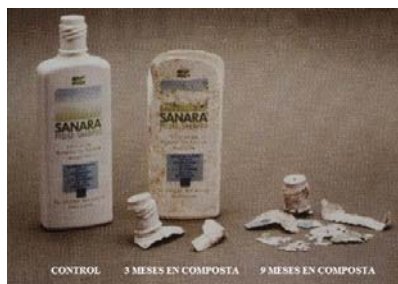
Figura 15. Degradación de botes hechos con PHAs mediante composta (D. Seebach, ETH).
