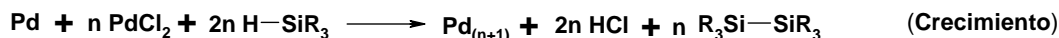
Esquema 48. Formación de nanopartículas de paladio a partir de la reducción de sales de Pd(II) con silanos.
