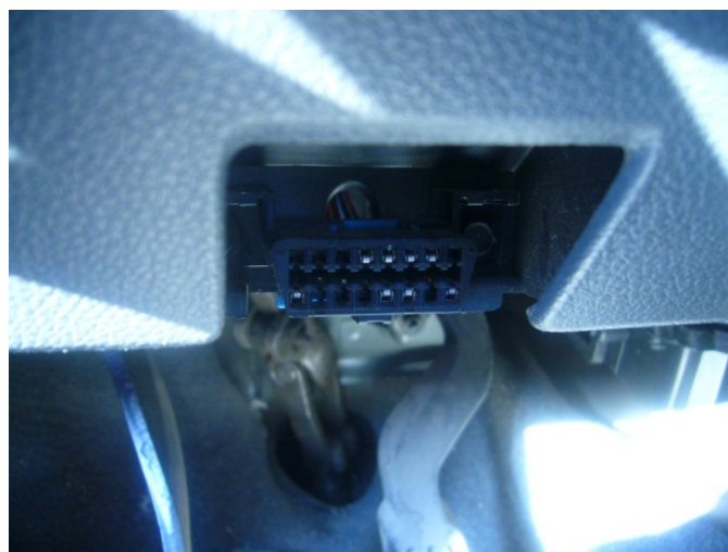
Figura 36. Conector OBD en la EcoSport .
