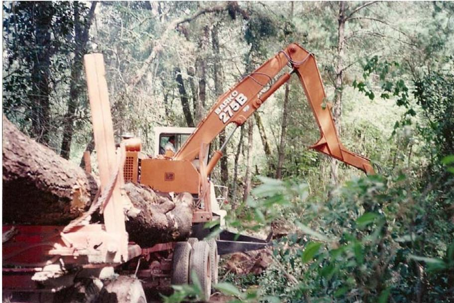
Aquí se aprecia la Grúa Barko realizando la carga al camión.
