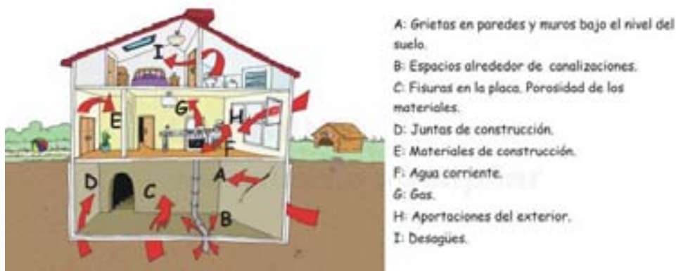
Figura 1.10: Posibles entradas de gas ^{222}\text{Rn} en el interior de una edificación [25]
