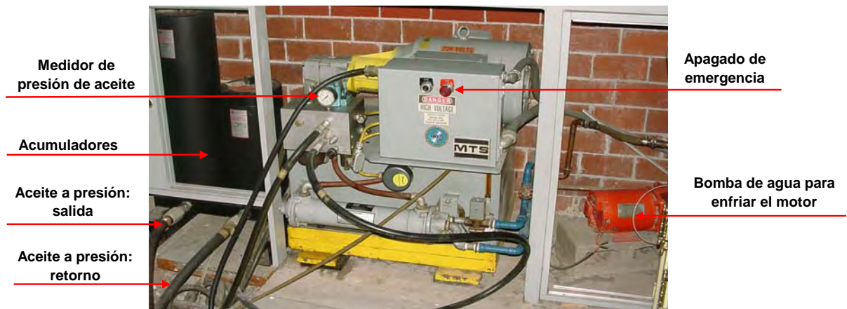
Figura 2.4 Sistema hidráulico para aplicar presión al pistón del equipo
