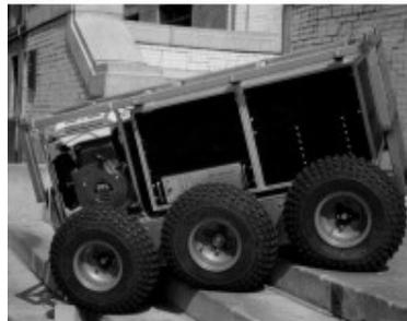
Figura 2.3 – Robot “Terregator” con locomoción Skid Steer de la Universidad de Carnegie Mellon
