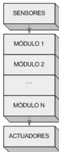
**Figura 5.1 – Arquitectura *pipeline* (Modelo tradicional)**
