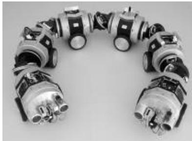
**Figura 2.8 – Robot “MAKRO” de configuración articulada de GMD
