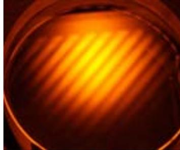
Figura 3.13 Interferencia entre dos planos ópticos.
