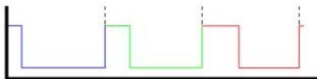
PWM para recorrer todo el rango de operación del servo
