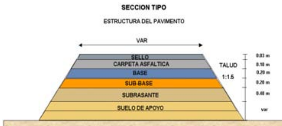
Figura 14. Sección Tipo de Pavimento Flexible
