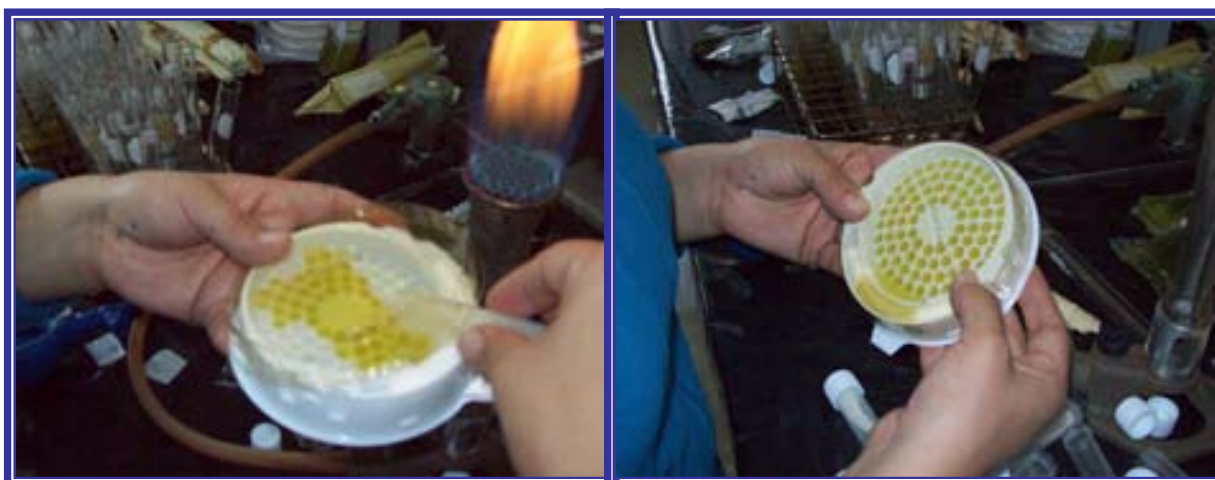
Figura 5.12 Vaciado de la solución en la placa llenando cada uno de los depósitos.
