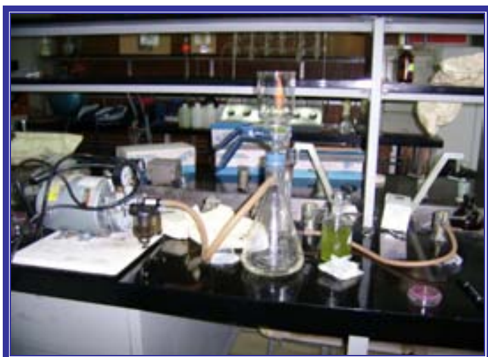
Figura 5.6 Equipo de filtración.
