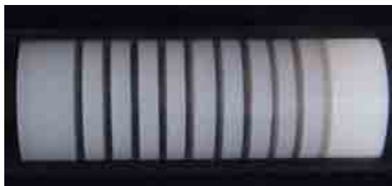
Figura 2.6. Maniquí Defrise fabricado con discos de lucita y poliestireno.
