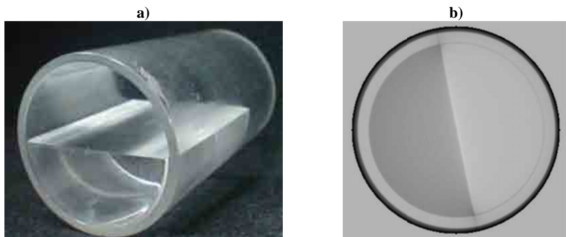
Figura 3.23. a) Maniquí de lucita utilizado para obtener un borde en las reconstrucciones axiales, b) Reconstrucción axial del maniquí de borde para medir la ESF.
