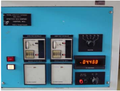
Imagen 20: Instrumento medidor de conductividad térmica marca Dynatech R/D modelo Rapid K. Reproducción realizada con fines didácticos
