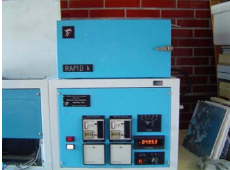
Imagen 16 : Instrumento medidor de conductividad térmica marca Dynatech R/D modelo Rapid K. Reproducción realizada con fines didácticos
