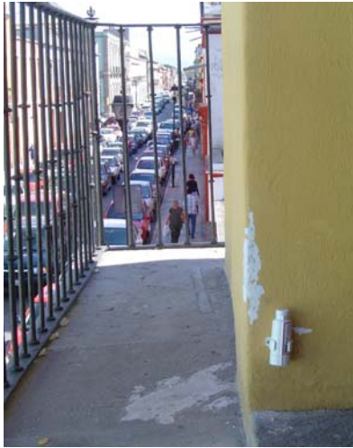
Imagen 14: HOBO® Exterior colocado en la fachada norte. Reproducción realizada con fines didácticos
