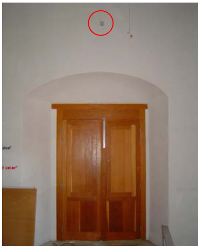
Imagen 15: En el círculo se observa el HOBO Interior colocado en el edificio. Reproducción realizada con fines didácticos
