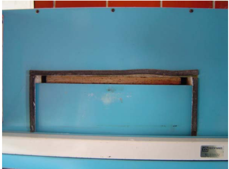
Imagen 19: Panel aglomerado de partículas de madera OSB colocado en el instrumento medidor de conductividad térmica marca Dynatech R/D modelo Rapid K.
