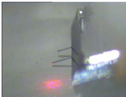
Figura 24 Fotografía de una punta o cantilever y el haz de luz láser
