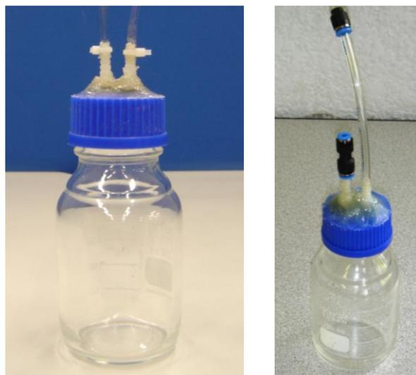
**Figura 4.2** Botellas utilizadas como reactores
