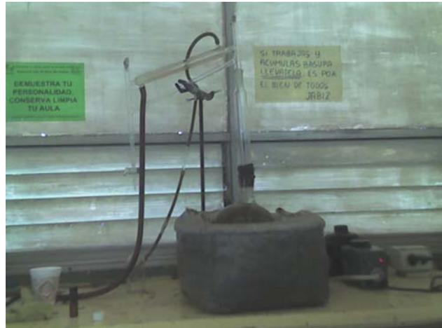
Empleando este aparato se pueden destilar por arrastre de vapor continuo de 100 a 500g de planta fresca, con un buen rendimiento. En los casos que el rendimiento sea bajo se puede colocar  $\pm 500$  ml de agua para obtener los aceites. Se colectan los aceites, se refrigera a  $0^{\circ}$  C por 24 hrs. para separar el agua de la mezcla. Este procedimiento se llevo a cabo en los dos tipos de plantas.
