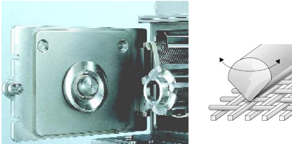
Fig 6 Tamizador con oscilador (Malla y oscilador)
