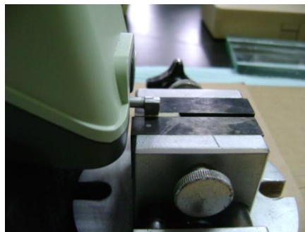
Fig. 26. Montaje de la muestra para pruebas de perfilometria
