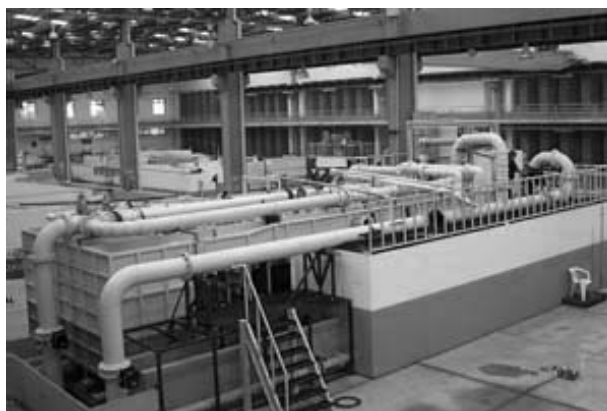
Figura 5.7 Tanque volumétrico con el cual se calibró el medidor.
