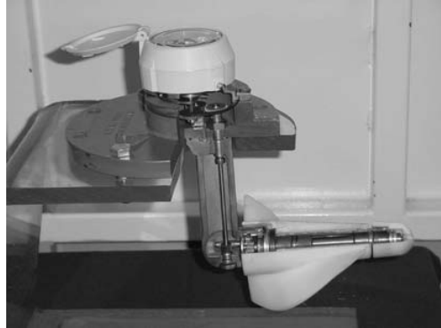
Figura 2.7 Transmisión y otras partes de un medidor de propela (Cortesía de Medidores Azteca).
