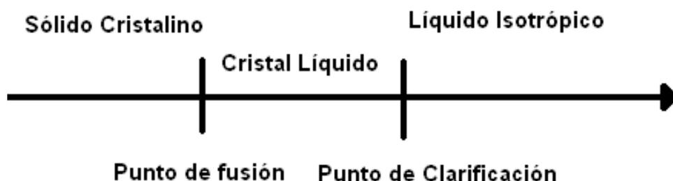
**Figura 2.1** Diagrama de fases de los CL en función de la temperatura.
