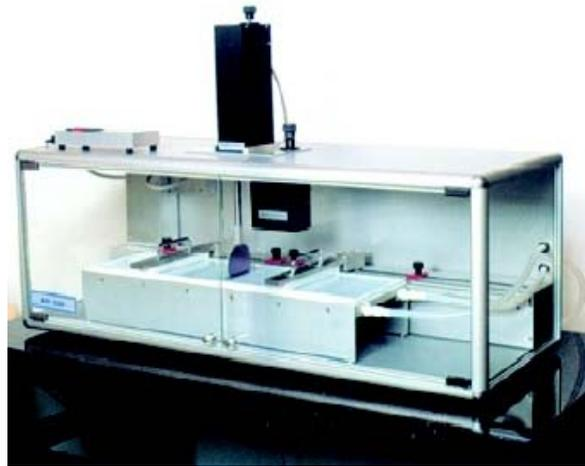
**Figura 2.21** a) Descripción del equipo de Langmuir; b) Equipo para la fabricación de las películas de Langmuir.
