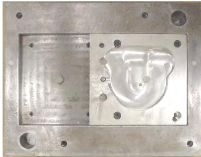
Figura 3.3 Molde inserto para la placa móvil.
