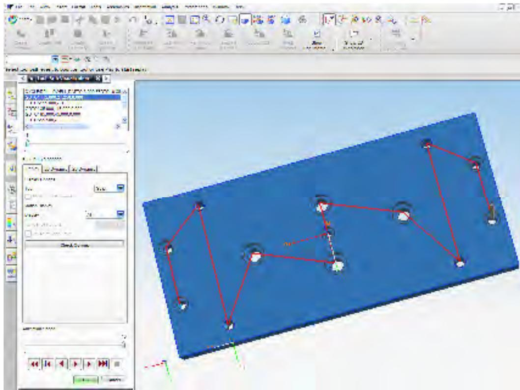
Figura 2.9 (a). Broca de centro para 13 barrenos y colocar tornillos de ensamble y pernos.
