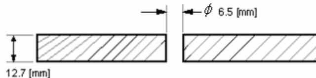
Figura 1.14. Dimensiones del barreno de la colada en el molde intercambiable superior de aluminio.
