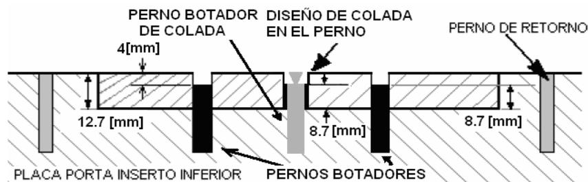
Figura 1.12. Ubicación del perno botador a partir de la base del molde intercambiable inferior, perno botador de vela o mazarota, distancia vertical fija entre los pernos botadores y los pernos de retorno.
