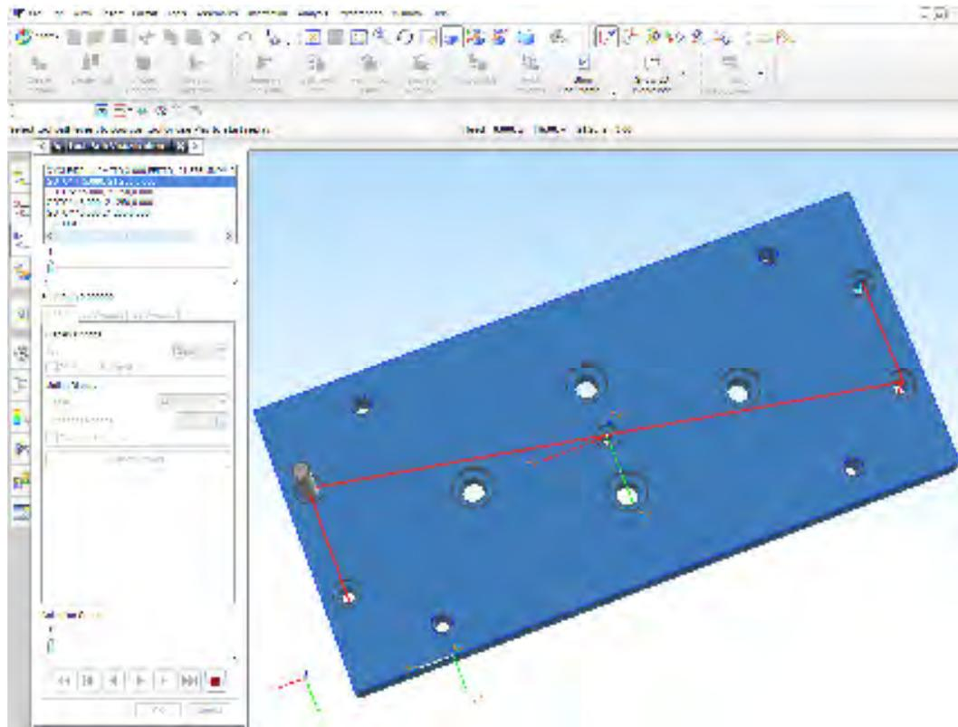
Figura 2.9 (e). Barreno  $\frac{1}{4}$  para colocar 4 pernos de retorno.
