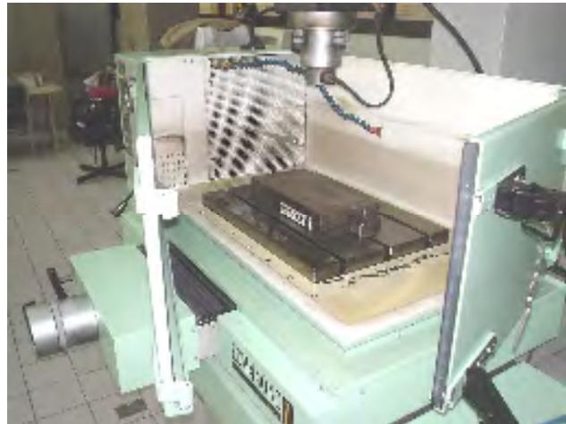
*Figura 2.17. Maquina electroerosión ENGEMAQ EDM 440 NC.*
