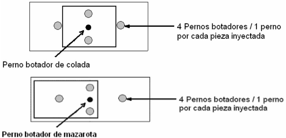
Figura 1.7. Piezas que se pueden expulsar con un sólo perno botador.
