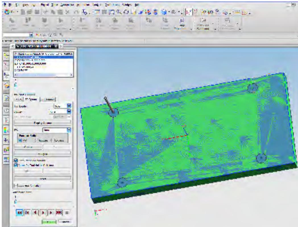
Figura 2.8 (a). Broca de centro para colocar 4 tornillos.
