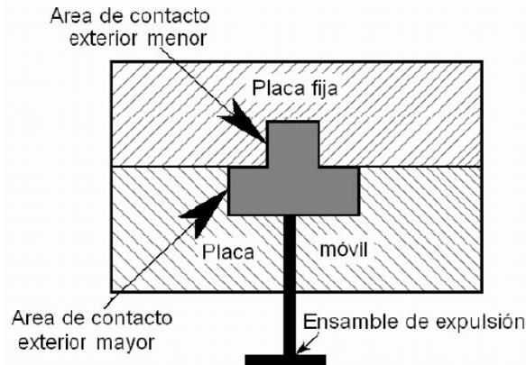
Figura 1.6. Orientación de la pieza entre la placa móvil y la placa fija.
