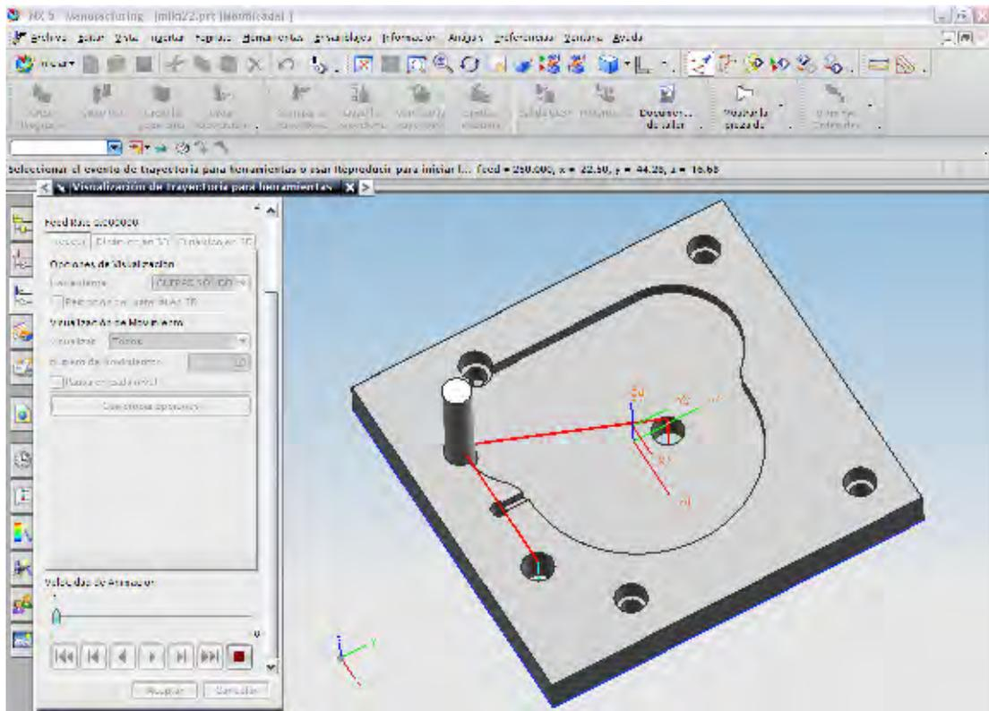
Figura 3.6 (d). Barreno 3/8 para perno botador de pieza.
