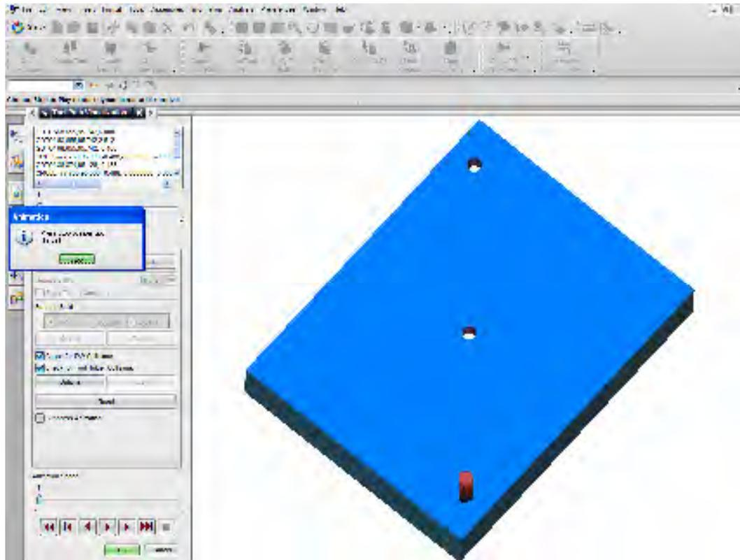
Figura 2.10 (b). Barreno Broca  $\frac{1}{2}$  pasada para la boquilla de inyección y perno guía.
