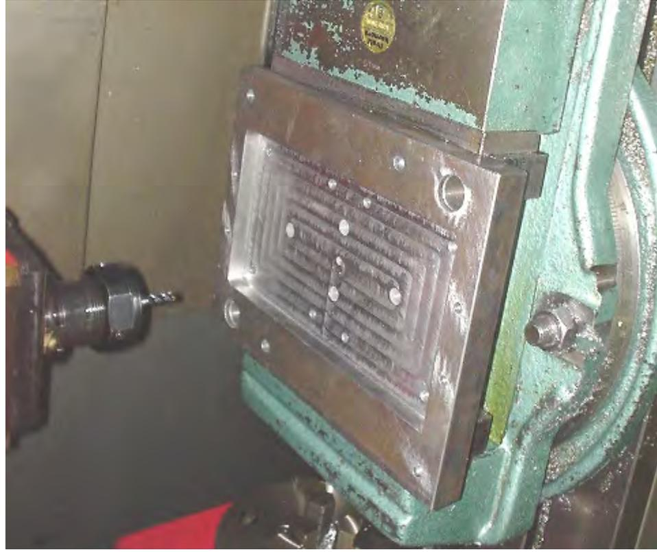
Figura 2.4. Manufactura de placa móvil parte superior.
