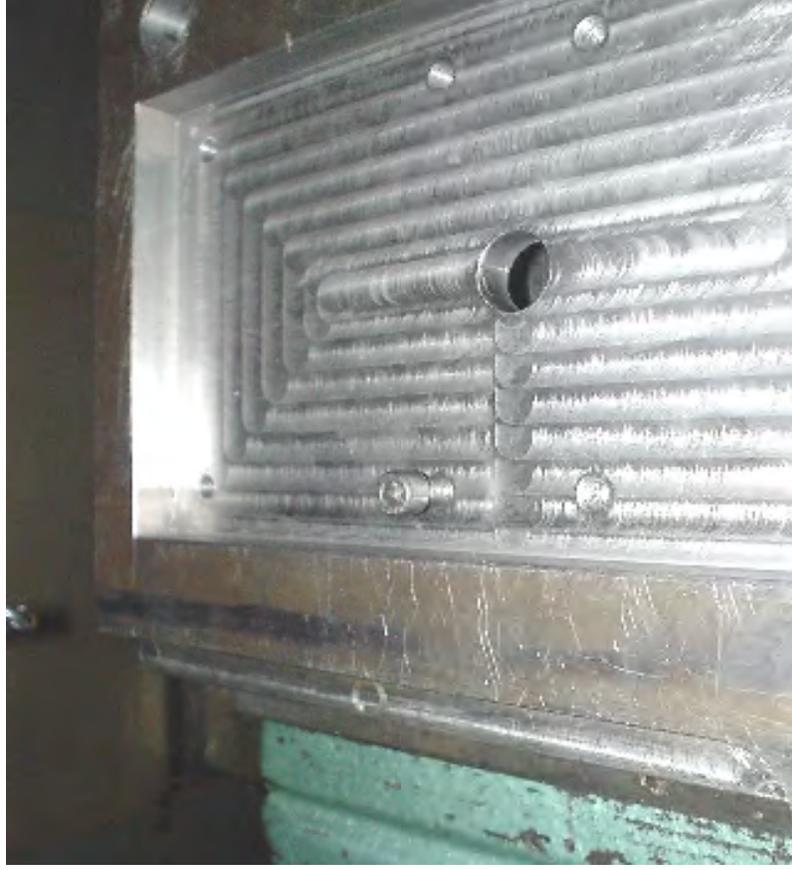
Figura 2.3. Colocación de un tornillo para el ensamble del inserto.
