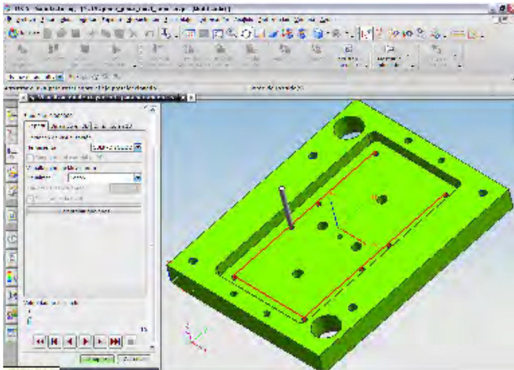
Figura 2.12 (i). Una braca F para 8 barrenos que se usaran para utilizar un machuelo 5/16.
