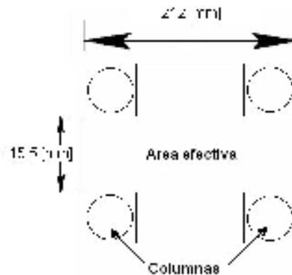
Figura 1.2. Área efectiva del molde, dependiendo de la distancia entre las columnas.
