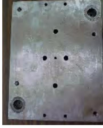
Figura 2.6. Camisas de pernos guía ensamblados.
