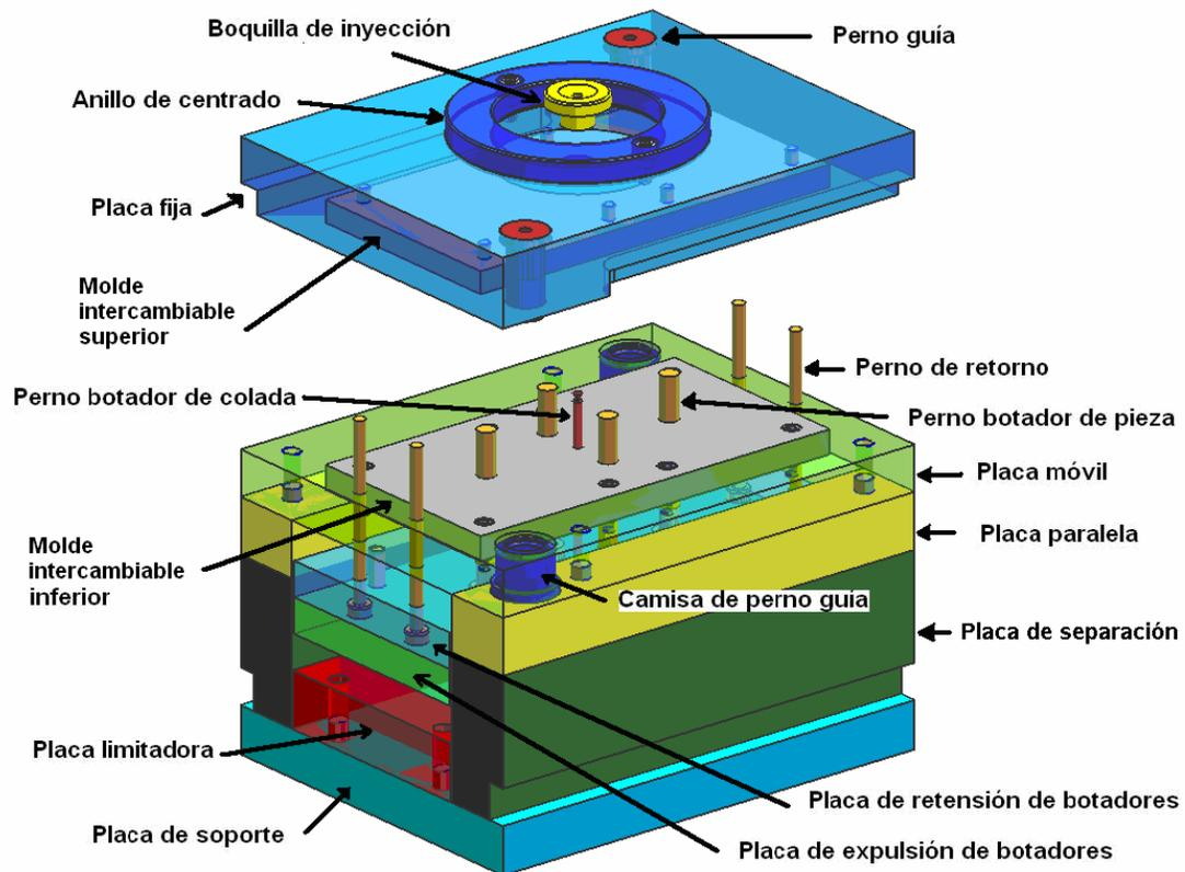
Figura 1.11. Modelado del porta moldes para confirmar los parámetros finales.
