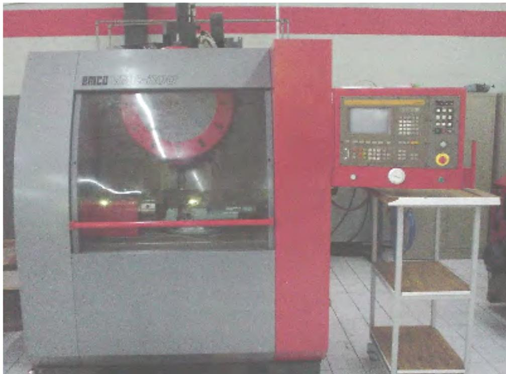
*Figura 2.7. Máquina-herramienta EMCO VMC 300.*
