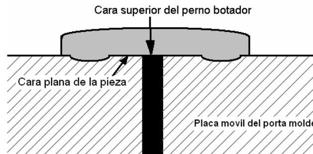
Figura 1.1. Perno botador que toca una cara plana de la pieza.
