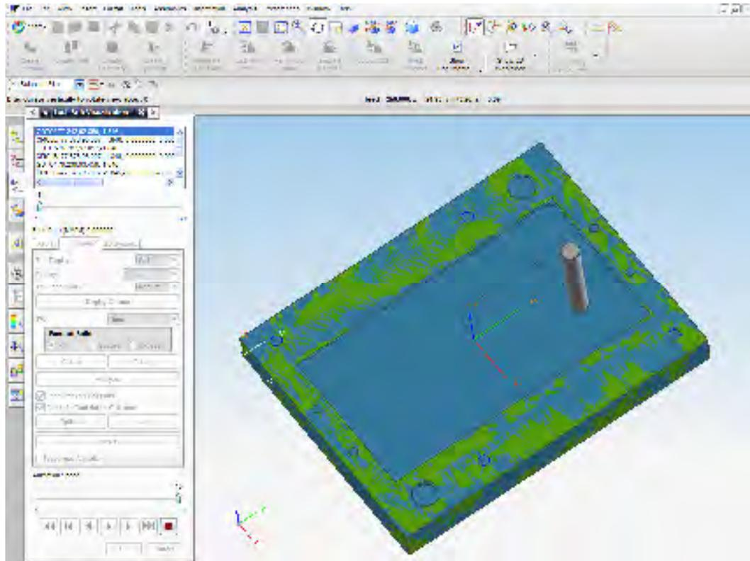
Figura 2.12 (a) Desbaste de caja cortador 1/2 para colocar el molde intercambiable.
