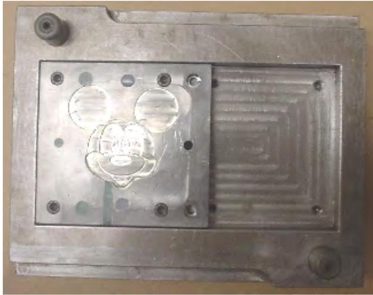
Figura 3.4 Molde inserto para la placa fija.
