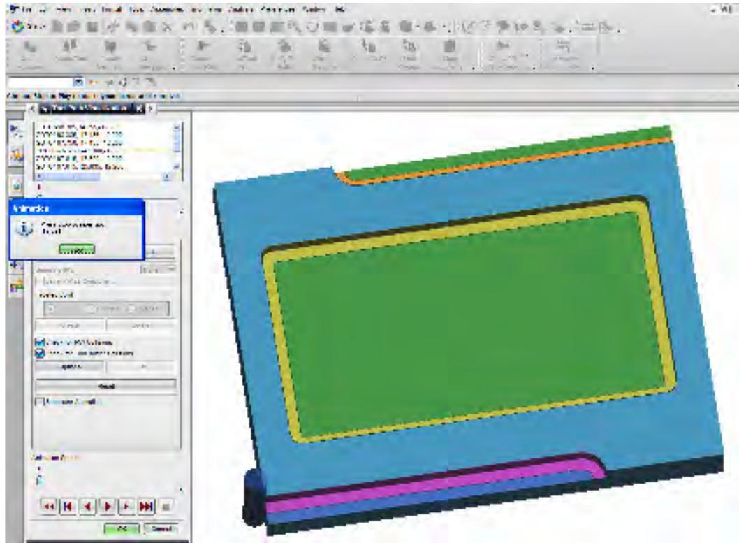
Figura 2.11 (d). Acabado de la parte de la sujeción de la placa usando un cortador de 1/2.
