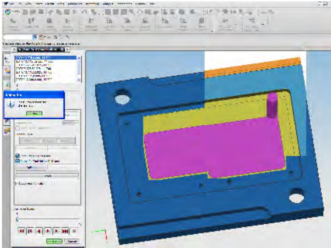
Figura 2.11 (b). Acabado de caja usando cortador de  $\frac{1}{2}$  para colocar el molde intercambiable.
