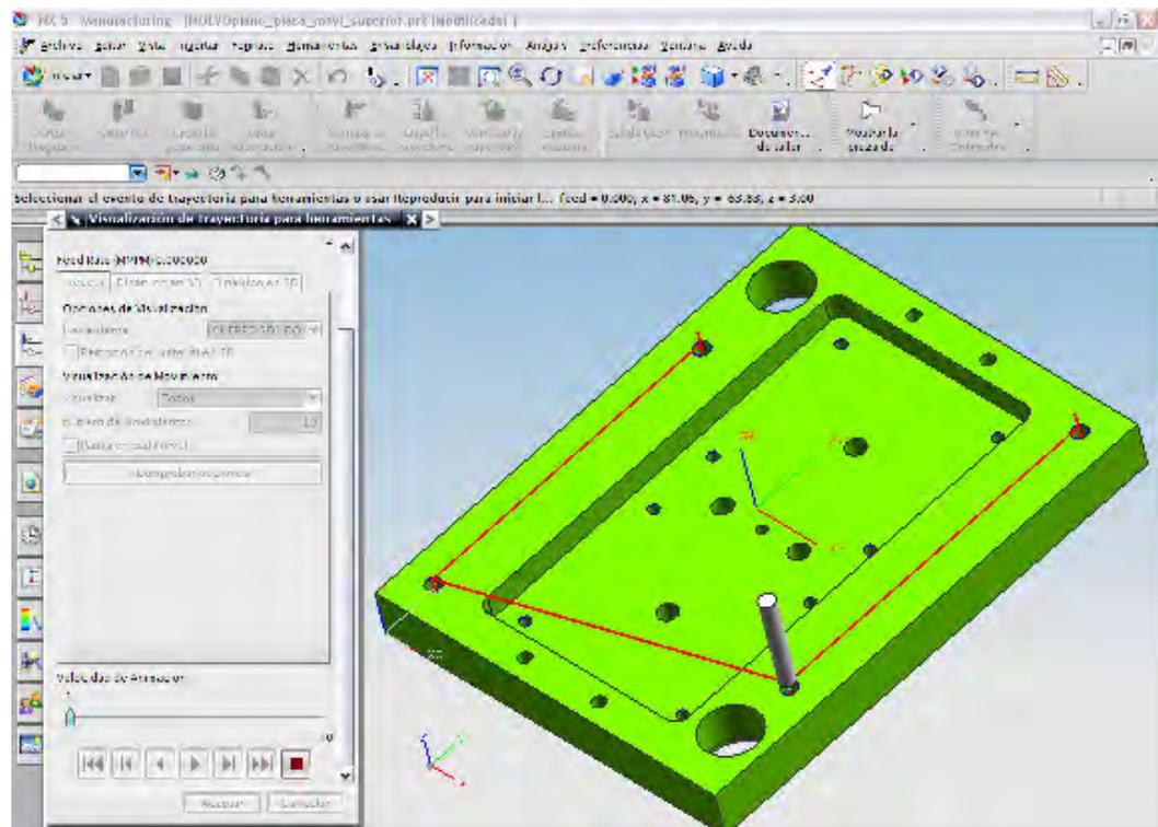
Figura 2.12 (e). Barreno 5/16 para cuerda con machuelo 3/8.
