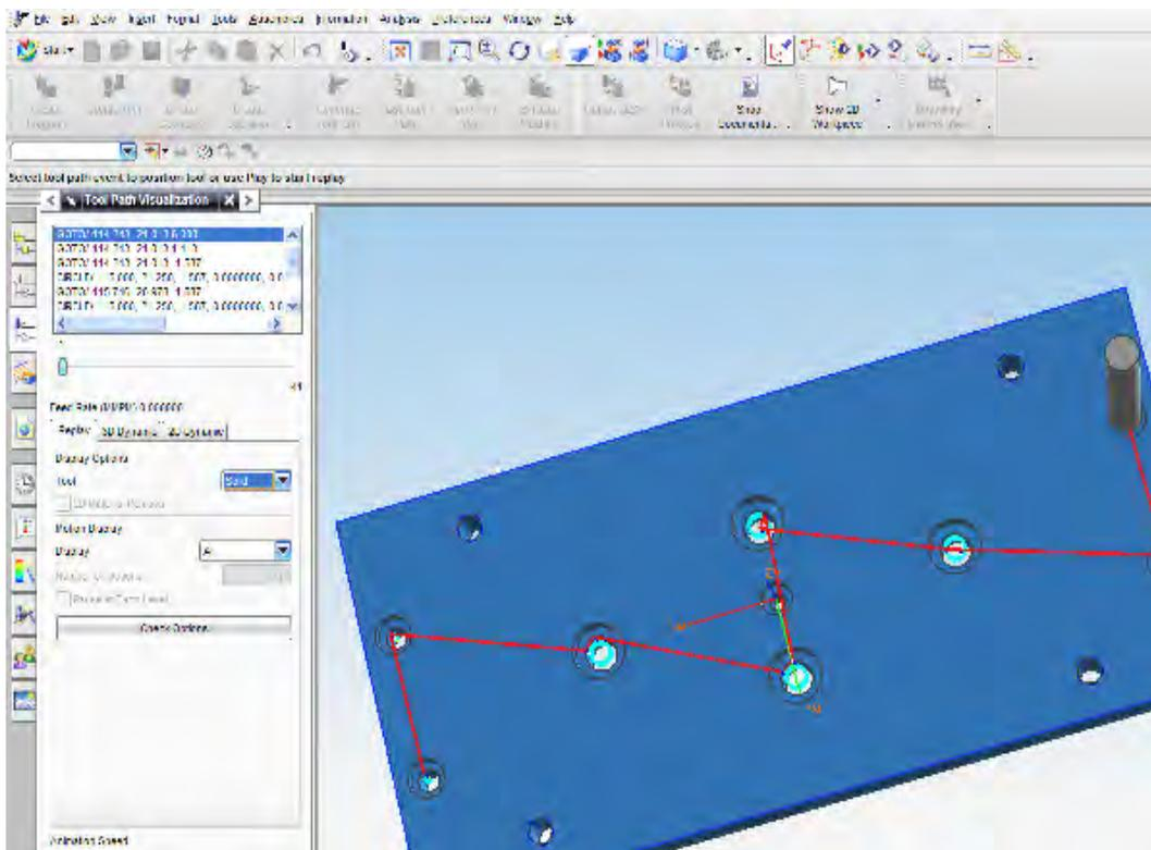
Figura 2.9 (f). Trayectoria del cortador  $\frac{3}{8}$  para cajas de perno de retorno y perno botador de colada.
