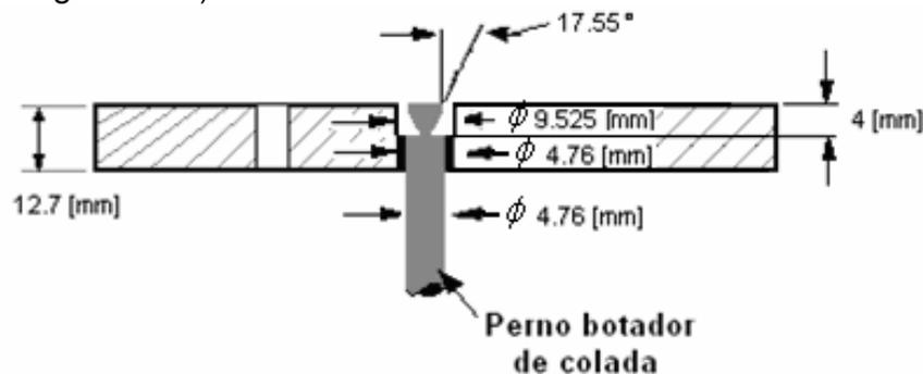
Figura 1.15. Dimensiones del cono de la colada en el molde intercambiable inferior de aluminio.
