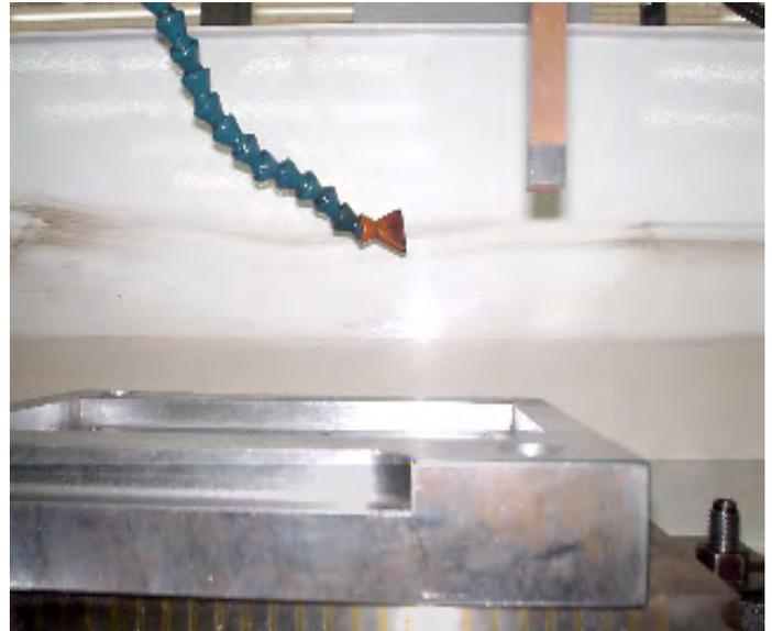
*Figura 2.20. Electro erosión de la placa fija para encuadrar los contornos para colocar los moldes intercambiables.*
