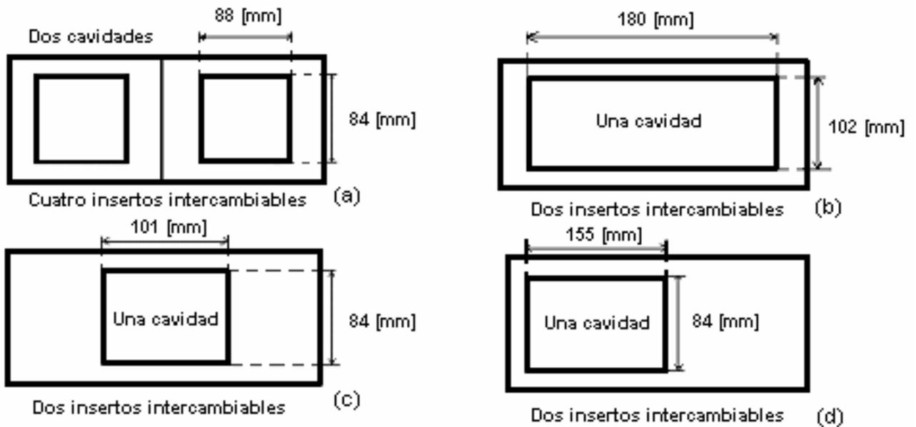
Figura 1.3. Inserto propuesto y arreglo propuesto para las cavidades.
