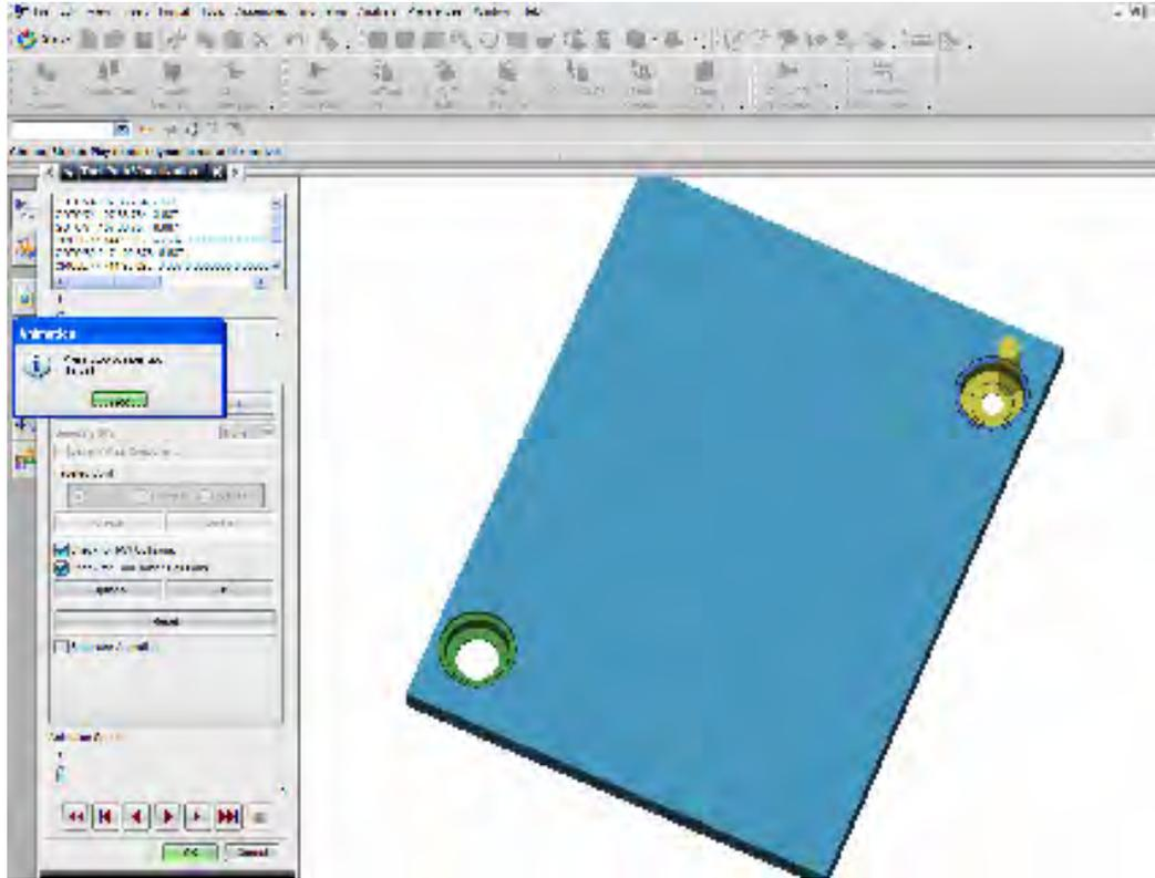
Figura 2.13 (e). Acabado de cajas para colocar el perno camisa de perno guía.
