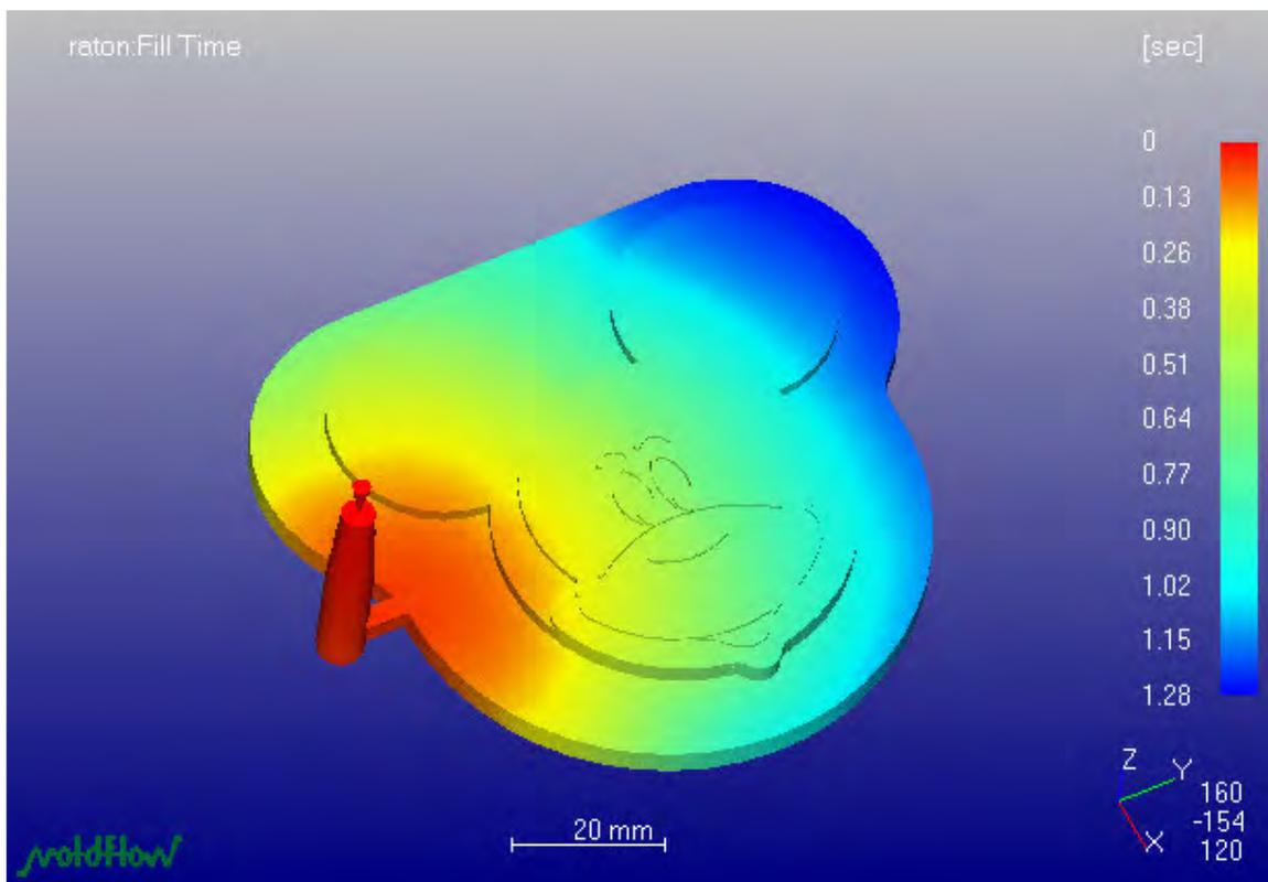
Figura 3.5. Tiempo de inyección para PE
