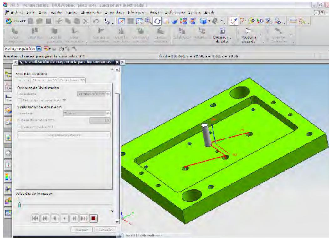
Figura 2.12 (f). 4 barrenos de 3/8 para colocar los pernos botadores de pieza.
