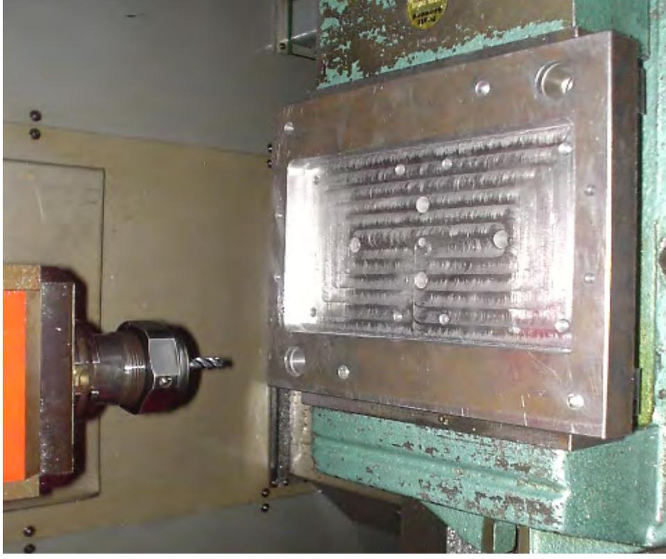
Figura 2.5. Placa móvil parte superior
