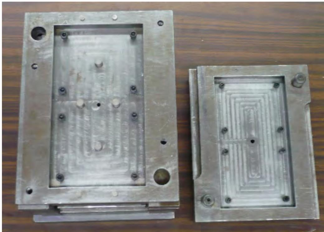
Figura 3.1 Porta molde para inyección de plástico.
