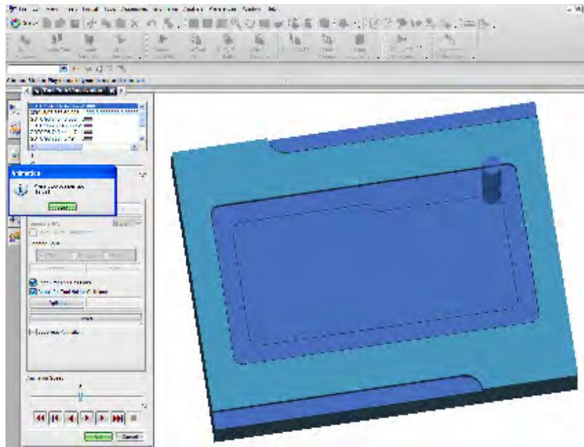
Figura 2.11 (a). Desbaste de cajas usando cortador de  $\frac{1}{2}$
