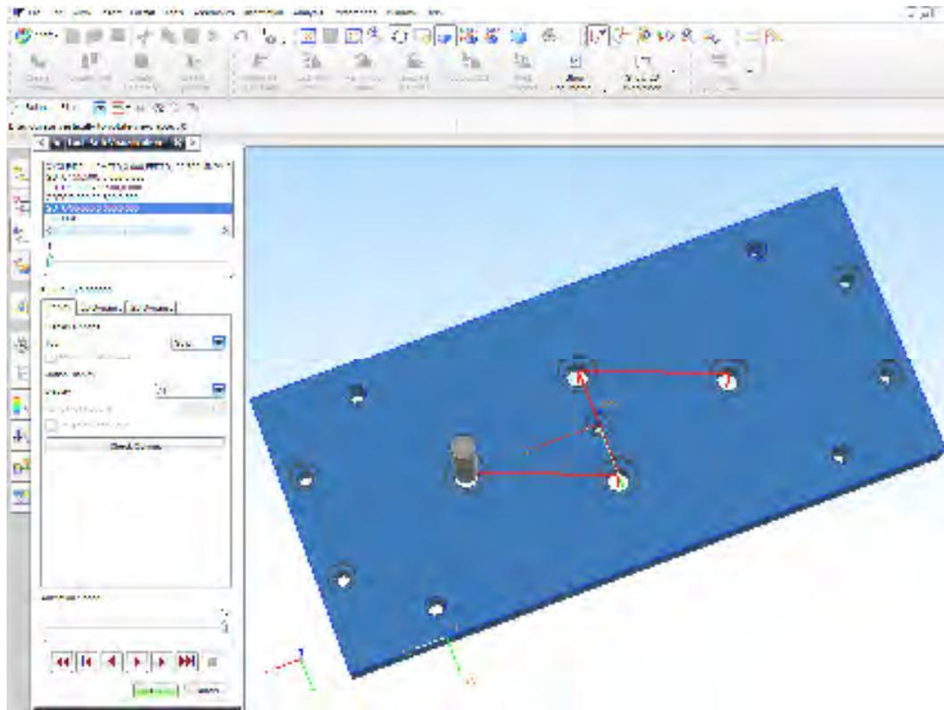
Figura 2.9 (c). Barreno 3/8 para colocar 4 pernos de botado de pieza.
