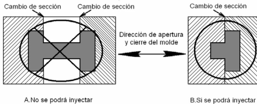
Figura 1.4. Geometrías con máximo un cambio de sección en dirección de la apertura del porta moldes.
