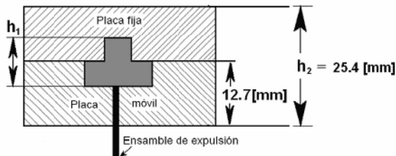
Figura 1.5. Altura de la pieza.
