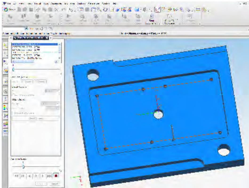
Figura 2.11 (e). Broca de centro para colocar 8 tornillos de ensamble del molde intercambiable.
