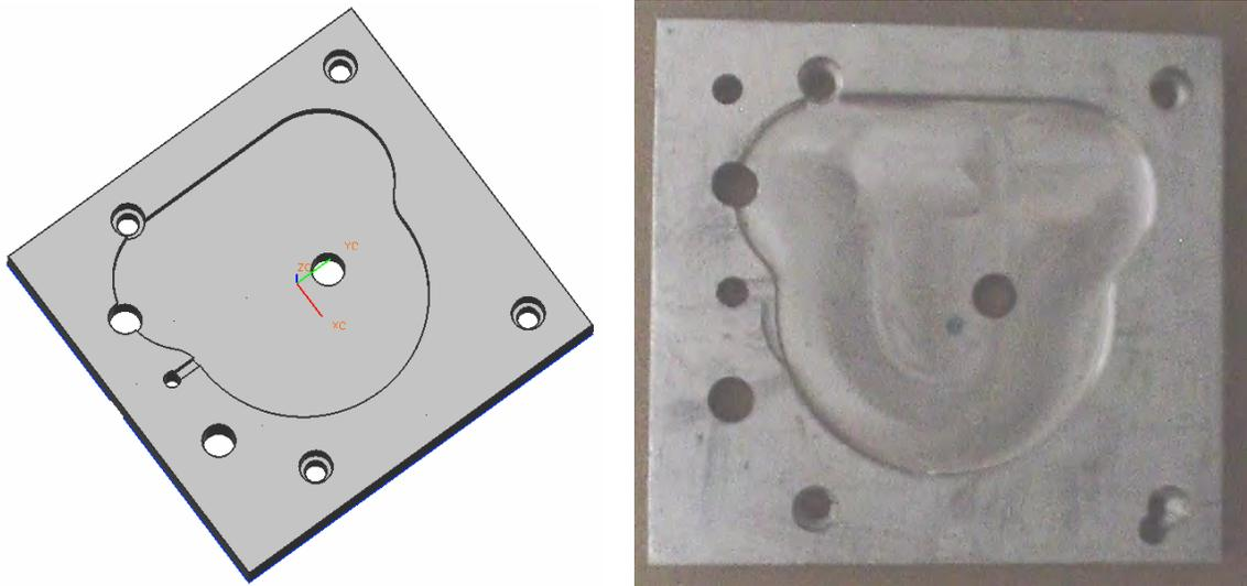
Figura 3.2 Molde inserto inferior para placa móvil.
