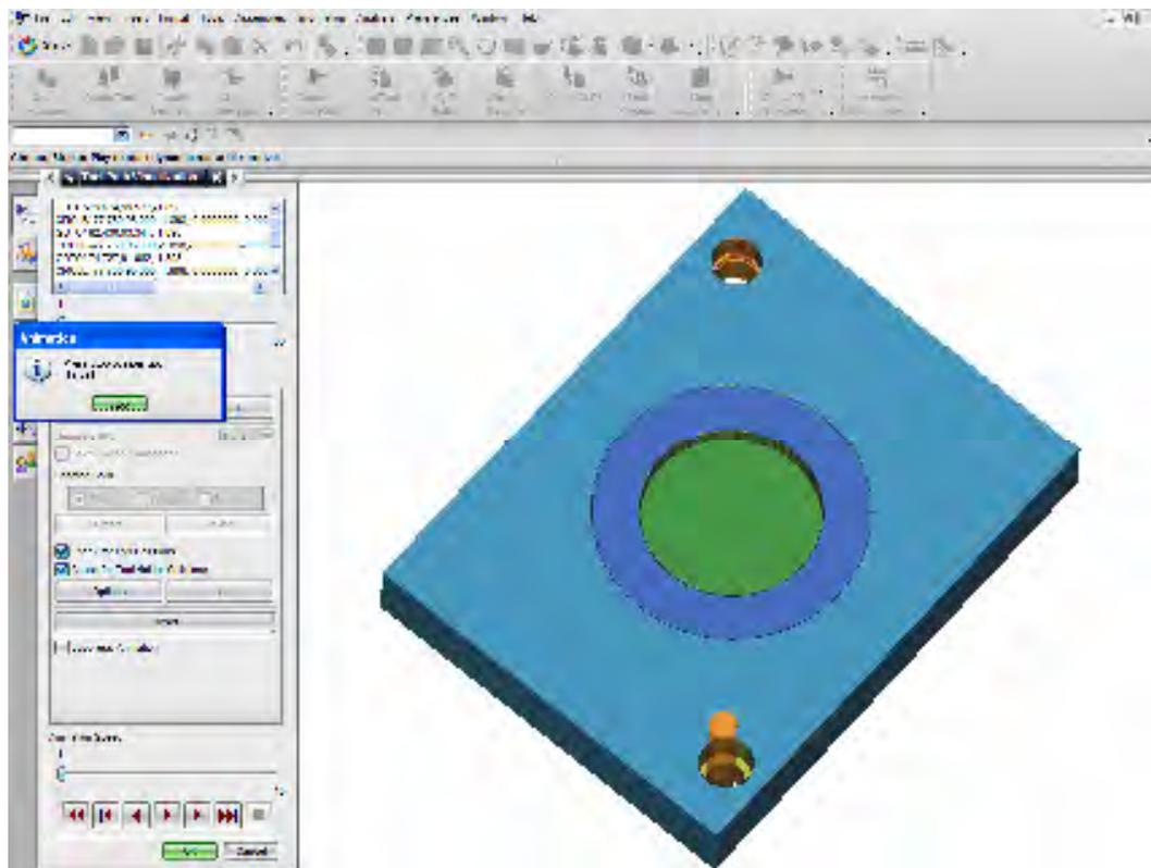
Figura 2.10 (c). Desbaste utilizando un cortador  $\frac{1}{2}$  para cajas.
