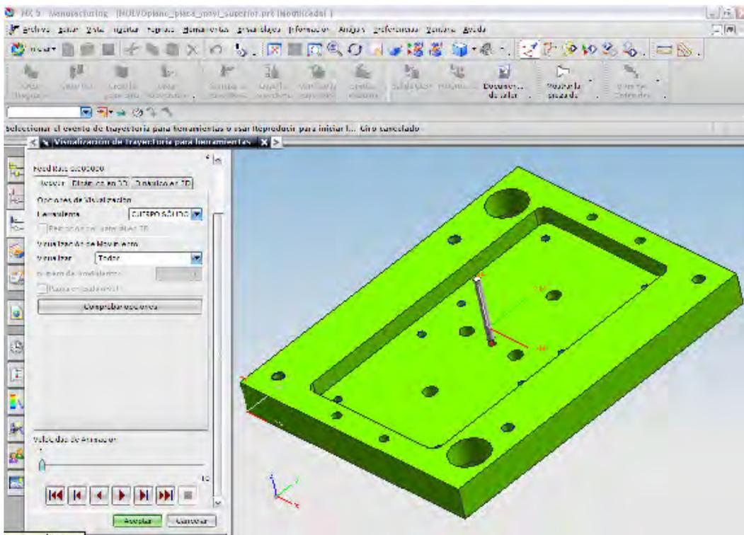
Figura 2.12 (g). Un barreno de 3/16 para el perno de colada.
