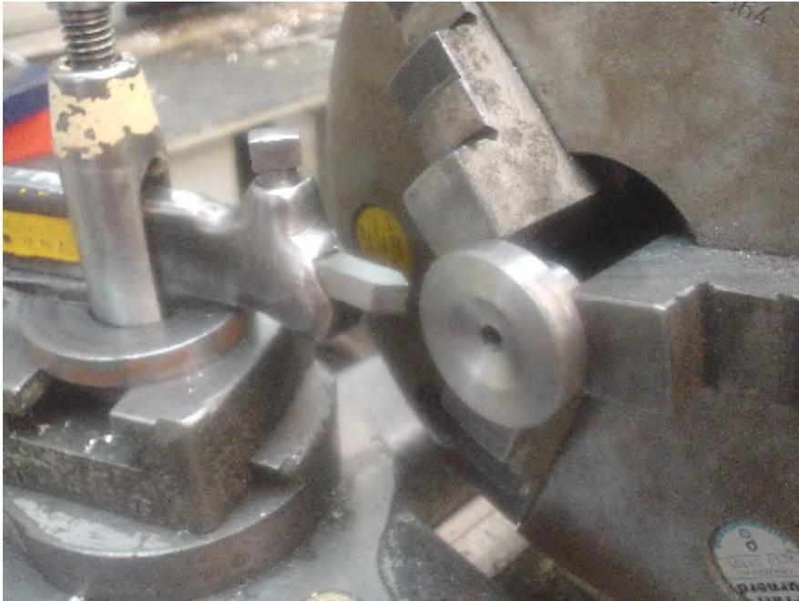
Figura 2.14. Desbaste de la boquilla en torno manual.
