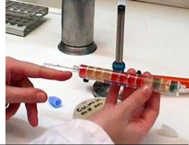
Fig. 3.10 Volver a insertar la guía (sin esterilizar) en BBL Enterotube II, utilizando un movimiento giratorio en todos los compartimientos, hasta que la muesca de la guía se alinee con la abertura del tubo. La punta de la guía debe estar visible en el compartimiento de citrato. Cortar la guía en la muesca mediante torsión.
