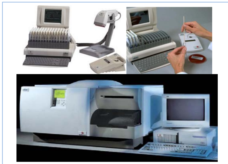
Fig. 3.35. Los componentes del Vitek 2 System son la caja del instrumento, el dispositivo de proceso de la muestra y lectora/incubadora, el puesto de trabajo de la computadora, que proporciona el análisis y el almacenamiento de datos e informes epidemiológicos, la Smart Carrier Station que es la interfaz directa entre el microbiólogo y el instrumento, y un escáner de código de barras para facilitar el ingreso de los datos. 1,6
