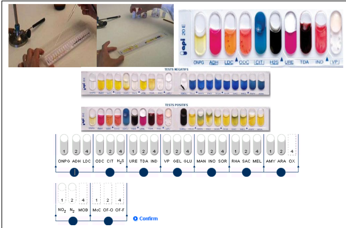
Fig.3.30 Tiras API20-E mostrando el método de la inoculación y la apariencia de la tira luego de la inoculación y la incubación. Se transfiere con una pipeta una suspensión del microorganismo a ensayar a cada una de los 20 compartimientos de medio. Las reacciones de color son leídas después de 18-24 horas de incubación a 35°C. El fabricante entrega hojas de trabajo para registrar las interpretaciones visuales de las reacciones colorimétricas, que luego son convertidas en números biotípicos de siete dígitos. 15
