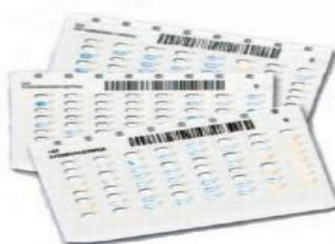
Fig. 3.36. La tarjeta para prueba de sensibilidad a antimicrobianos Vitek 2 contiene 64 cubetas con concentraciones múltiples de hasta 22 antibióticos. El antibiótico se rehidrata cuando se introduce la suspensión de microorganismo en la tarjeta durante el proceso de llenado automatizado. 1,6
