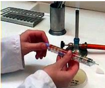
Fig. 3.7 Retirar las dos tapas. La punta de la guía de inoculación se encuentra debajo de la tapa blanca. No someter al calor la guía.
