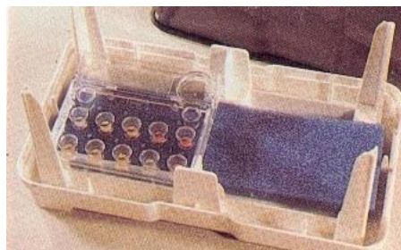
Fig. 3.26 (Figura de la derecha) se muestra la ubicación de la bandeja inoculada en la cámara humidificadora antes de la incubación.
