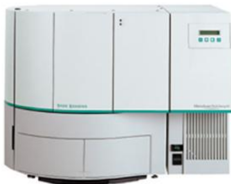
Fig. 3.37 Para incubación, lectura e interpretación automatizadas de pruebas de sensibilidad a antimicrobianos. Este mismo instrumento se usa para la identificación de bacterias. 1, 3,4
