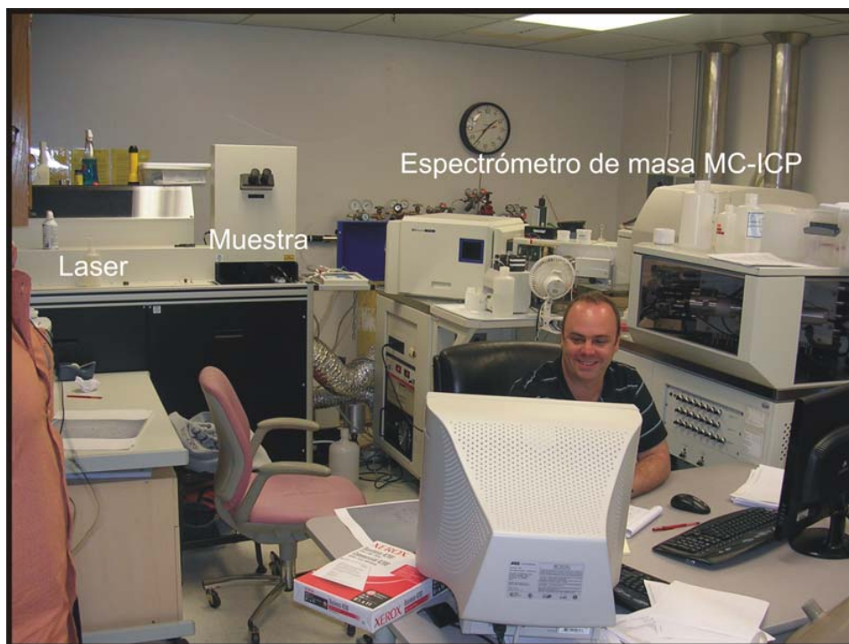
Figura 34 – Laboratorio de fechamiento isotópico U-Pb del Centro Laser Chron de la Universidad de Arizona (Tucson). La ablación se realizó con un láser New Wave/Lambda Physik DUV193 Excimer, que trabaja con una longitud de onda de 193 nm. Las mediciones isotópicas se efectuaron utilizando un sistema multicolector (laser ablation multicollector inductively coupled plasma mass spectrometry, LA-MC-ICP-MS).
