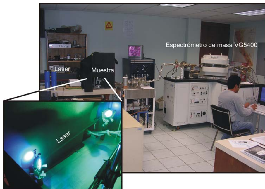
Figura 33 – Laboratorio de fechamiento isotópico por el método ^{40}\text{Ar}/^{39}\text{Ar} del Centro de Investigación y Científica y Educación Superior de Ensenada (CICESE). En la parte izquierda de la foto se puede observar la línea de extracción de argón, que utiliza un láser de iones de argón Coherent Innova 70C para el calentamiento de las muestras. En la mayoría de los experimentos, las mediciones isotópicas se realizaron utilizando un espectrometro de masa VG5400, ubicado en la parte derecha de la foto.
