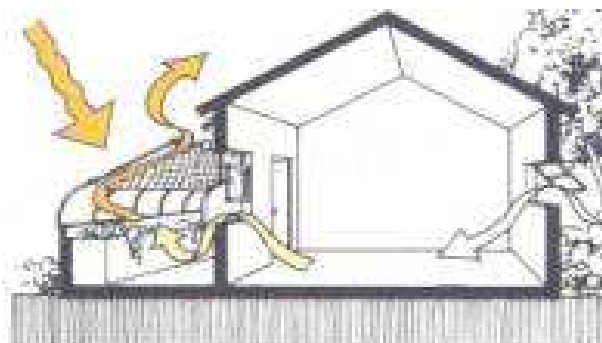
IMAGEN 19 Para poder enfriar en verano y calentar en invierno se propone el efecto invernadero. 44
