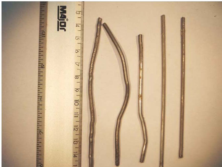
Fig. 4.42. Perfiles extruidos (izquierda) mostrando algunos defectos superficiales. Perfiles extruidos y probados a tracción (derecha).
