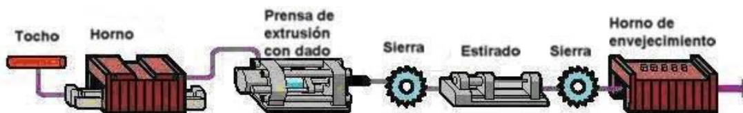
Fig. 2.6. Se muestran los pasos básicos para realizar la extrusión de perfiles de aluminio. Cortesía: Aluminios CONESA.
