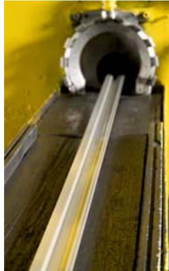
Fig. 2.2. Equipo de extrusión y producto extruido. Cortesía: Aluminios CONESA.
