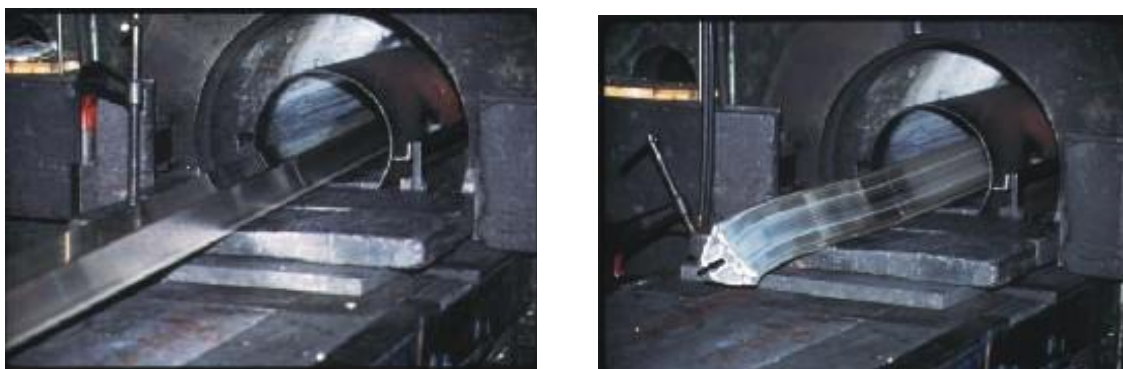
Fig. 2.5. Imagen izquierda, al inicio de la extrusión. Imagen derecha, producto continuo extruido. Cortesía: Aluminios CONESA.
