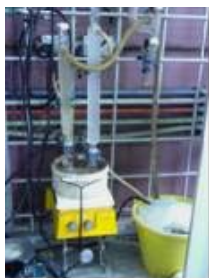
Figura 4.2 Baño de aceite para la determinación del número OH's
