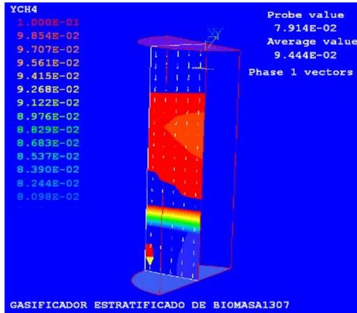
Figura 3.4 Fracción másica del CH<sub>4</sub>
