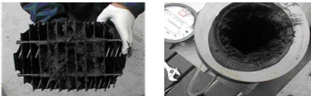
Figura 2.5 Problemas causados por alquitranes condensados en los equipos.
