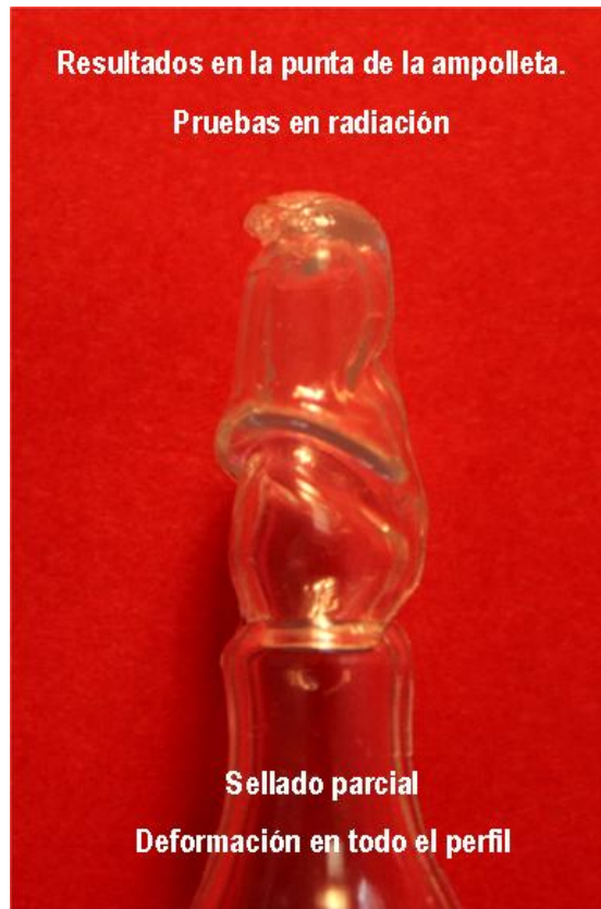
Figura 35. Resultados de la cuarta serie de experimentos en la punta de la ampollita.
