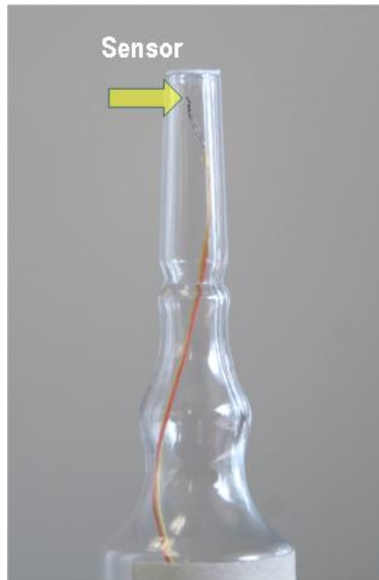
Figura 22. Colocación del sensor en la punta de la ampollita.
