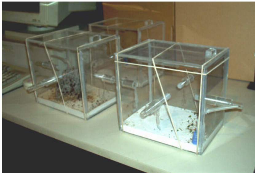
Figura 19. Disposición de los nidos de laboratorio. Se aprecian las tres cámaras que componen el nido y los tubos que las interconectan.
