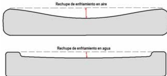
Figura 3.3 Ilustración de la forma del rechupe para los diferentes enfriamientos
