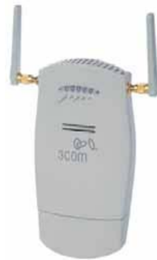
Fig. 4.19 Punto de Acceso (Access Point)
