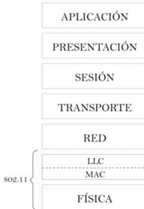
Fig. 3.2 Capas del modelo OSI que define el estándar IEEE 802.11
