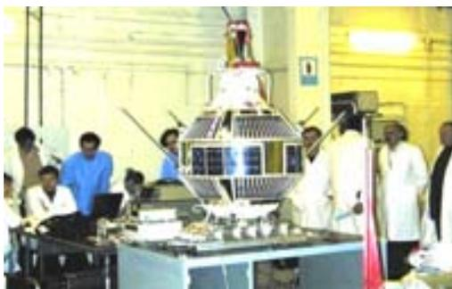
Microsatélite ensamblado (prototipo para nanosatélite) <sup>1,6</sup>
