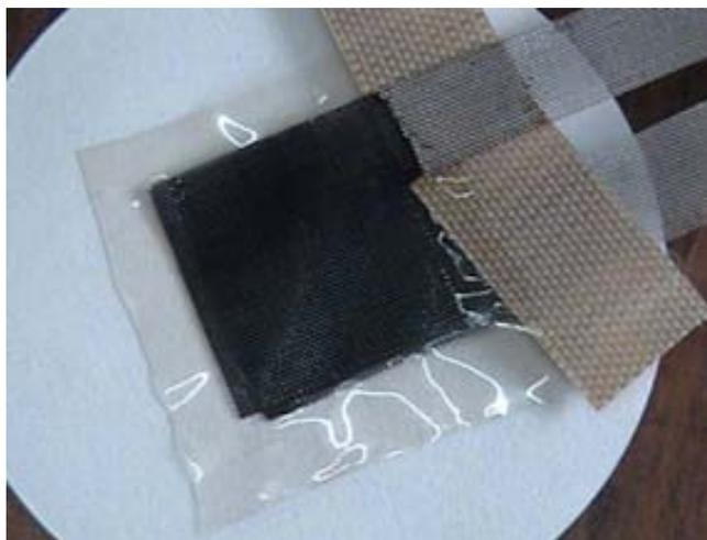
Figura 2.6.3. MEA realizado con prensado en caliente.
