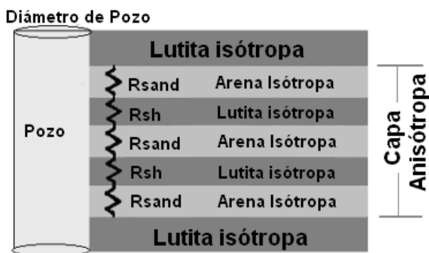
Figura 2. 7 Sistema de resistencias en serie, en una formación de intercalaciones de capas delgadas de arenas y lutitas, para estimar R_{tv} .
