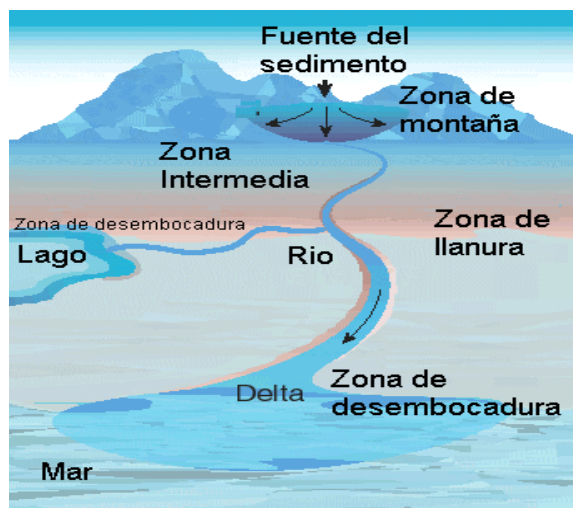
Figura 4. 2 Esquema de un sistema fluvial (oildfiel glossary, 2007).
