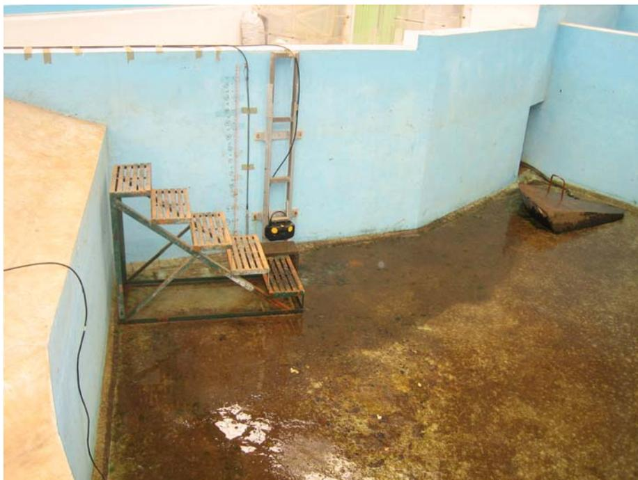
Foto 3- 1: Tanque de concreto vacío mostrando la escala lineal, transductor de presión y medidor ultrasónico
