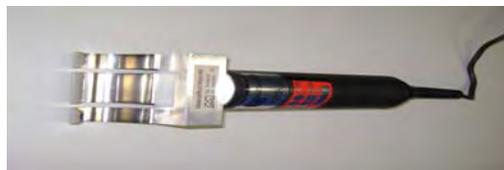
Fig. 3.6 Sensor de Humedad en Biomasa
