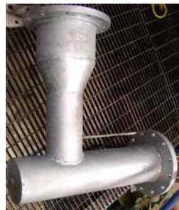
Fig. 2.15 Carcasa de tornillo Sin fin
