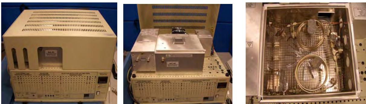
Fig. 2.23 Cromatógrafo de gases Buck Scientific 910.
