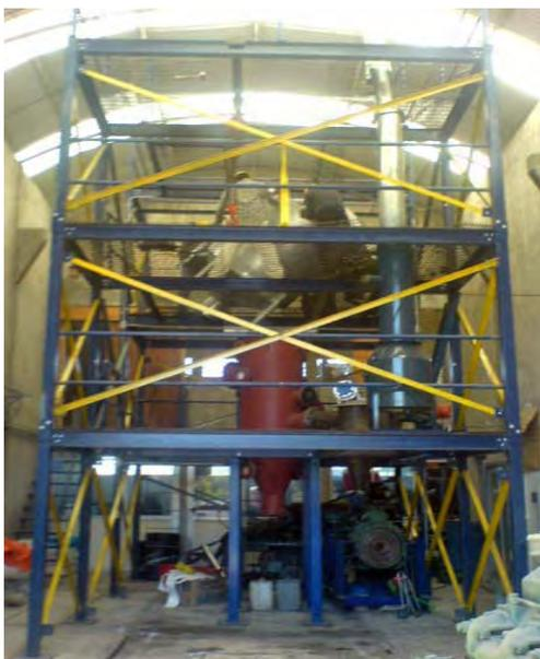
Fig. 2.26 Planta piloto de Generación de electricidad con capacidad de 250kW.
