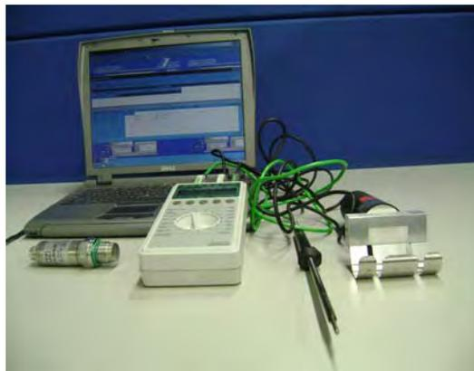
Fig. 3.10 Sistema de adquisición y almacenamiento de datos de temperatura, presión y humedad.
