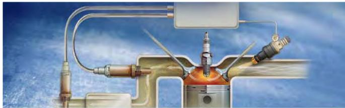
Fig. 3.25 Lazo Cerrado de Control Sensor Lambda
