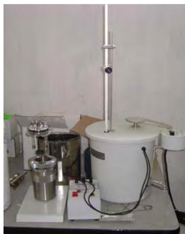
Fig.3.11 Bomba Calorimétrica Parr 1341
