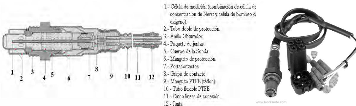
Fig. 3.27 Sonda lambda planar de banda ancha
