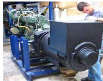
Fig. 2.25 Generador Eléctrico STANFORD ® HCI-434-C1L-0080E
