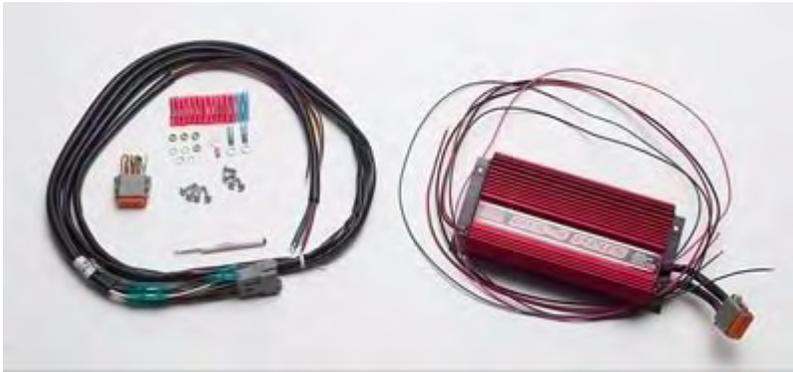
Fig. 3.36 Modulo de ignición MSD DIS-4.
