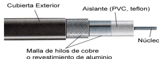
Figura 17 Componentes del Cable Coaxial
