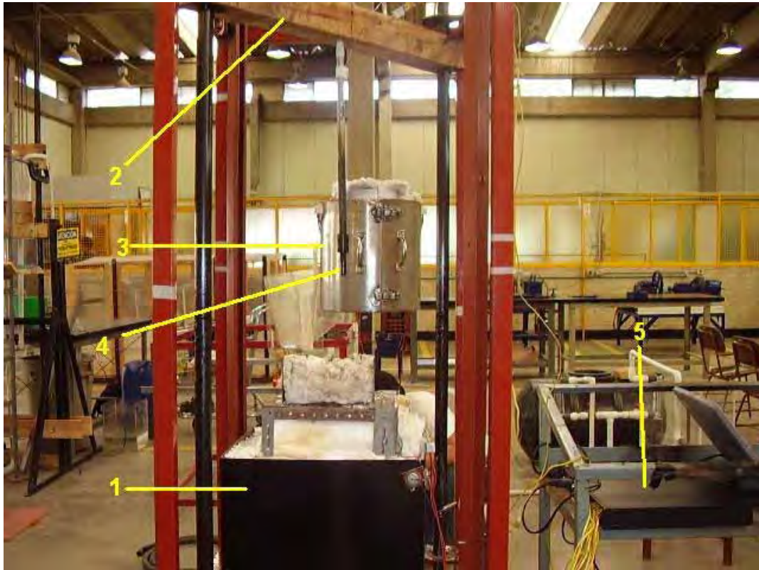
Figura 2.5. Fotografía del equipo experimental para el estudio térmico: 1) horno para el baño de sales, 2) dispositivo para trasladar a la probeta, 3) horno eléctrico para el calentamiento de la probeta, 4) probeta, 5) sistema de adquisición de datos.
