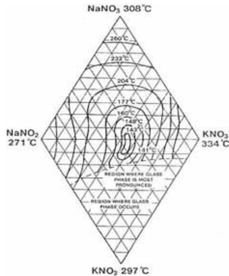
Figura 1.5. Diagrama ternario para NaNO 3 -NaNO 2 -KNO 3 -KNO 2 en los cuales se muestra la dependencia del punto de fusión con la composición de la mezcla de sales.
