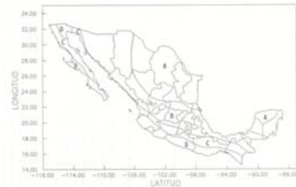
Figura 5.1 Zonas sísmicas CFE
