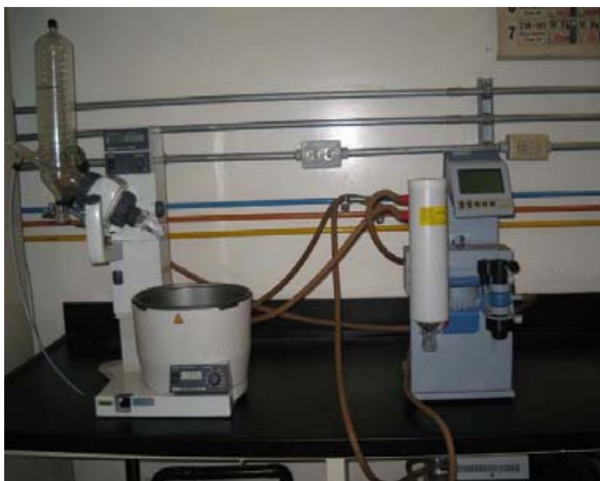
Figura 17. Rotavapor (izquierda) y bomba de vacío (derecha) utilizados para separar los disolventes orgánicos. Laboratorio de Prácticas de Química Orgánica, edificio Tlahuizcalpan, Facultad de Ciencias, UNAM.
