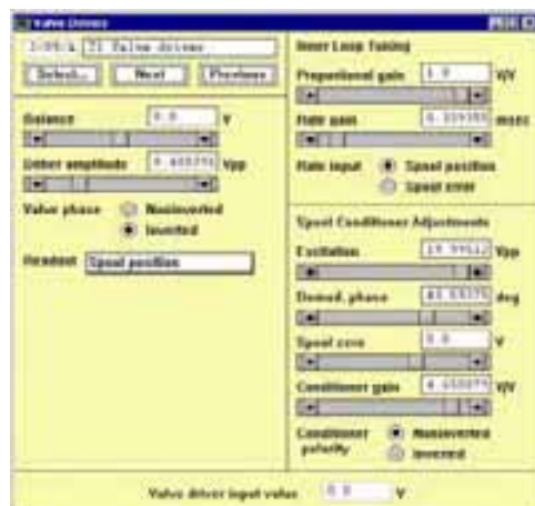
Figura 6.1.4. Ventana del programa de control de las servo-válvulas
