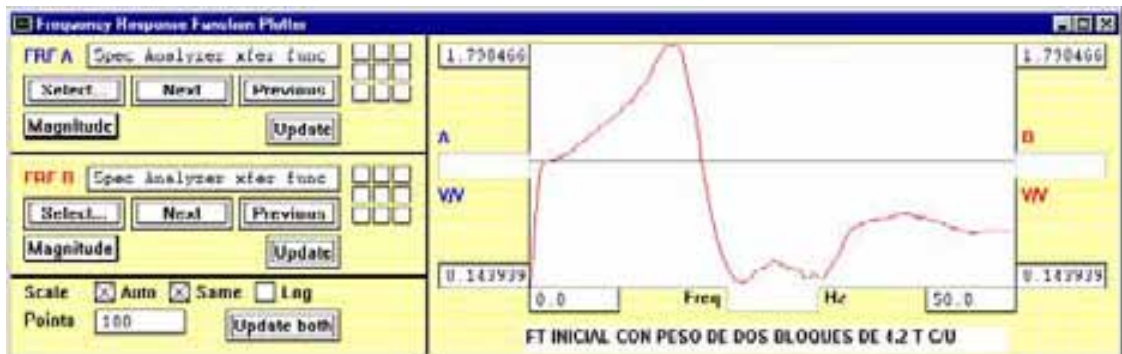
Figura 7.1.5 Función de transferencia con un peso 8.4 toneladas.
