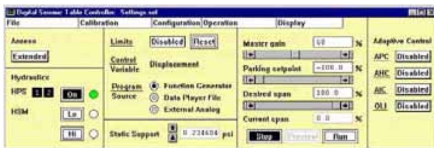
Figura 6.1.1. Ventana del programa de control de la Mesa Vibradora
