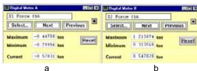
Figuras 6.1.6 a y b. En la figura "a" se muestra la ventana "Digital Meter A" con el canal "X1 Force fbk" y en la figura "b" la ventana "Digital Meter B" con el canal "X2 Force fbk" para la revisión de las fuerzas en cada uno de los actuadores
